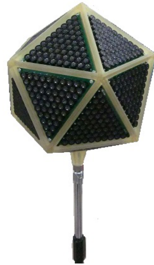
(b) 多面体 (正 20 面体) パラメトリック スピーカの写真
