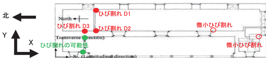
図2 ゴルカ地震後の調査で発見した建物1階内のひび割れ発生状況 (左が北、上が東) 6)
