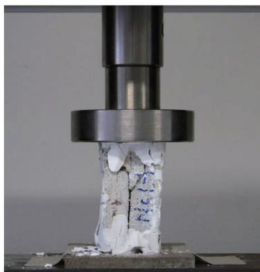
図10 圧縮試験の様子
