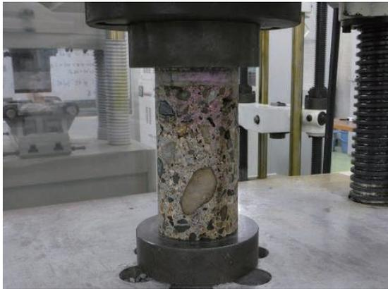
図14 圧縮強度試験の様子
