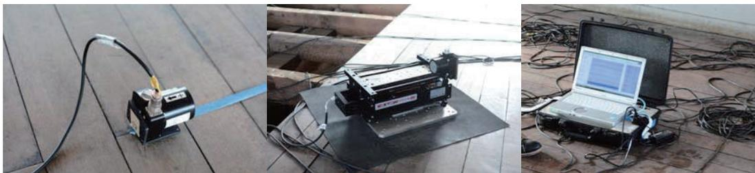
図2 微動センサー・起振機・収録装置
