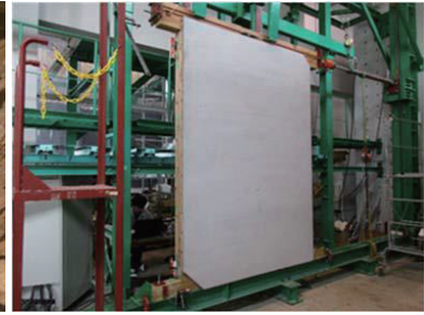
図13 耐力実験の様子
