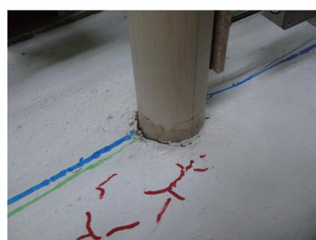
写真4 乾燥収縮によるひび割れ
