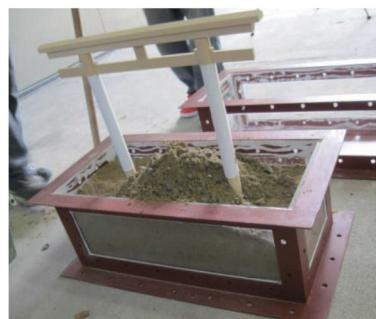
写真3b 版築地盤の捣き込み
