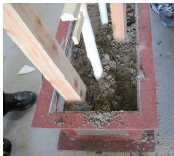
写真3a 三和土の捣き込み
