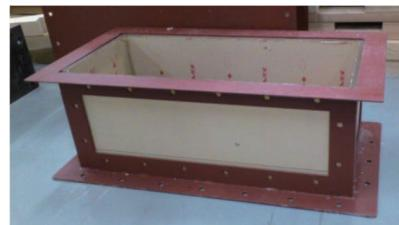
写真2 地盤製作用鋼製枠
