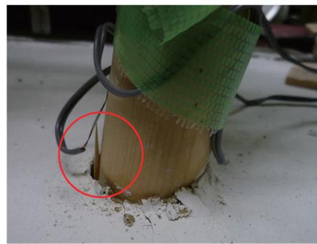
写真 7b 最大変形時の載荷側柱根元状況
