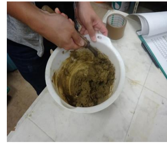
図8 粘度試験の状況
