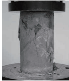
写真 3 繊維補強ポリマー・セメント により処理された供試体の破壊状況
