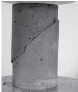
写真 2 ワイヤー・ブラシ 清掃処理の供試体破壊状況
