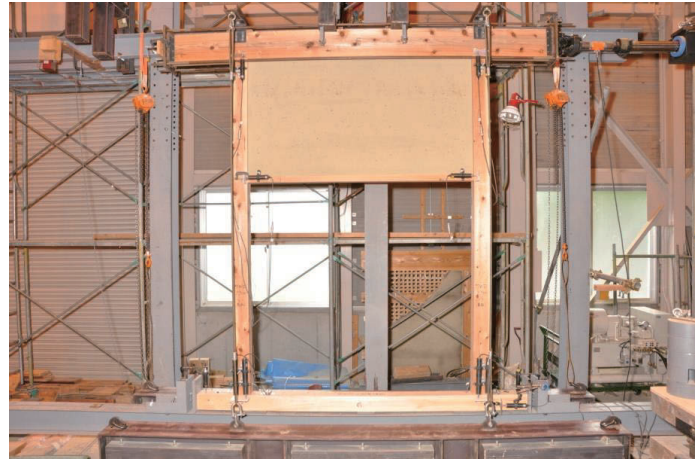
写真 1 MWD-T900 の設置状況
