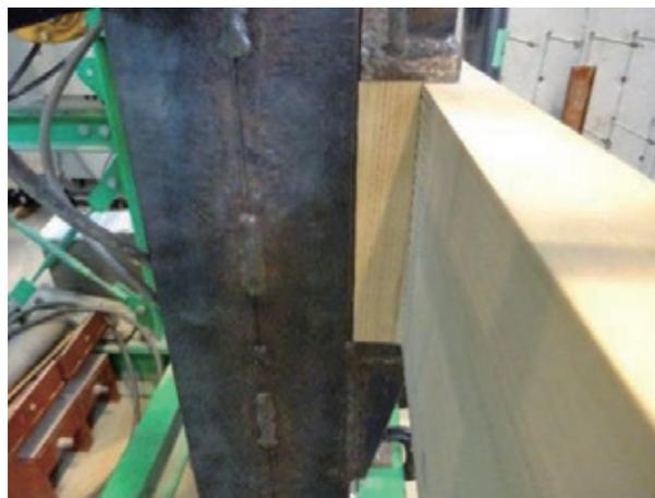
図14 要素試験体のめり込み部の状況
