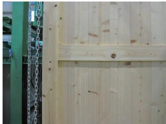
図4 試験体の貫-板壁接合部
