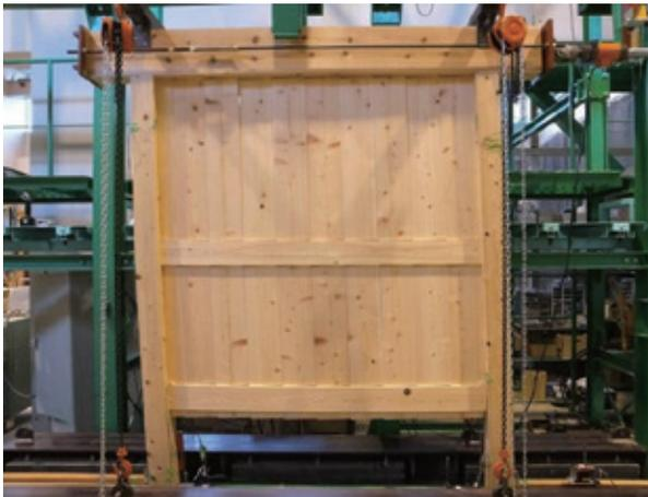
図5 試験体の設置および加力状況(1/30rad時)
