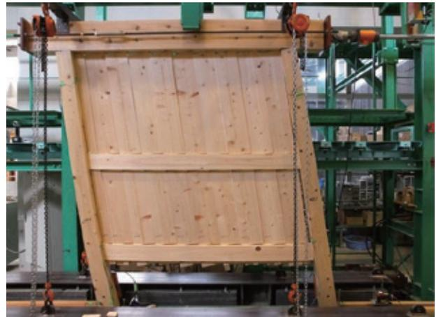
図6 試験体の最大加力状況(約1/7rad)
