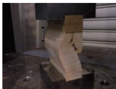
図 15 FHK-1 の破壊状況
