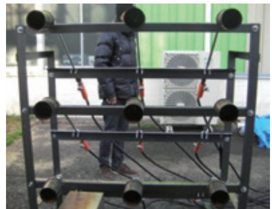
図7 実験のため製作した加熱機器
