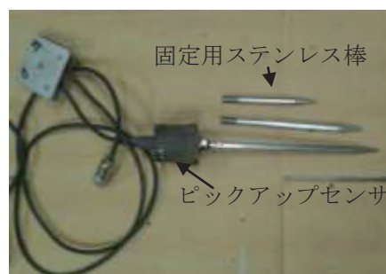
写真2 ピックアップセンサと固定用ステンレス棒
