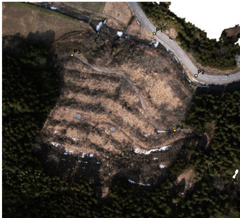
写真3 今回作成したオルソフォト画像及び基準点測量の位置
