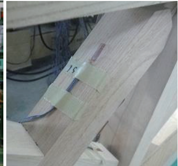
図7 ひずみゲージの貼付
