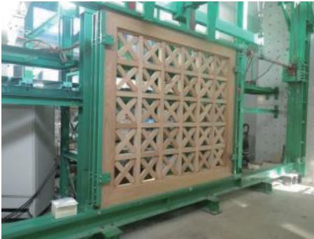
図5 試験体の設置状況
