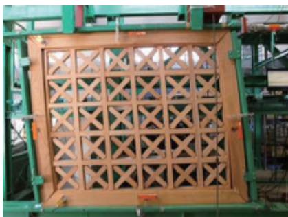
図8 大変形時の試験体
