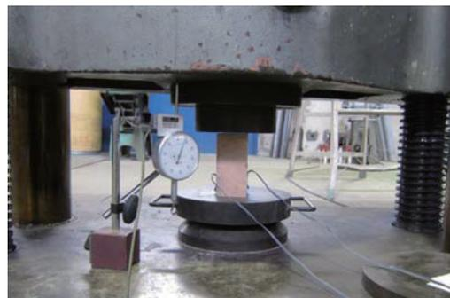
写真6 横圧縮試験の载荷状況
