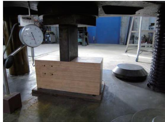
写真 7 めり込み試験方法 (左: 加力治具のみ / 右: ヒノキ材有り)
