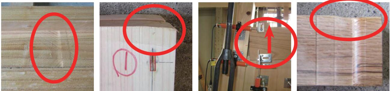
【梁(ケヤキ)の溝に生じた板壁によるめり込み跡】
