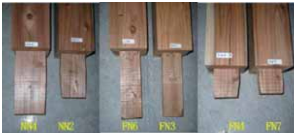
写真 7 新材の载荷後の変形状況
