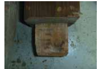
写真 6 短ほぞの変形状態 (FU5)
