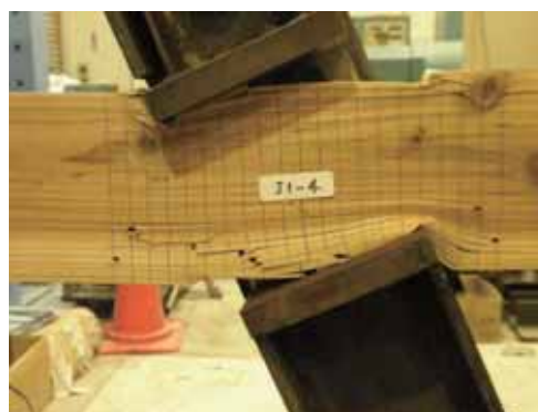
写真4 鋼製柱と貫のめり込み状況 (0.4rad)
