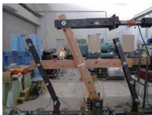
写真2 通し貫試験体載荷状況 (0.4rad)
