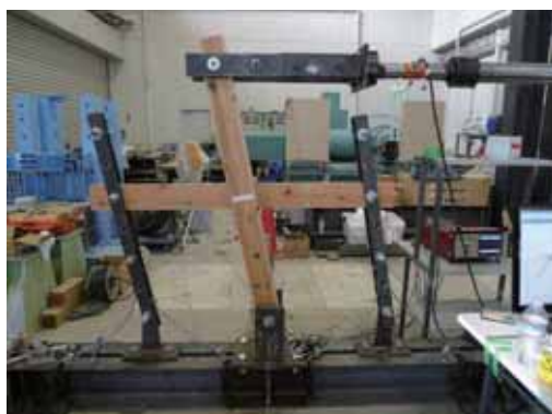
写真1 通し貫試験体載荷状況 (0.1rad)
