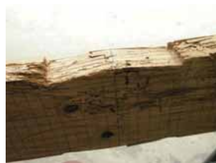
写真 5 J2-1 の虫食いスギ貫のめり込み変形
