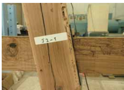
写真3 仕口と楔の変形状況
