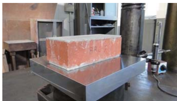
写真 2 レンガ試験体（一枚角レンガ）
