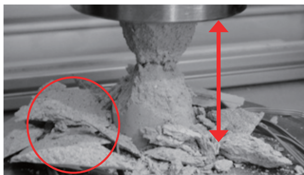
写真 5 モルタル試験体の破壊の様子
