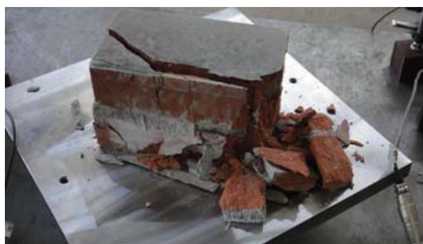
写真 6 レンガ積み試験体の破壊の様子
