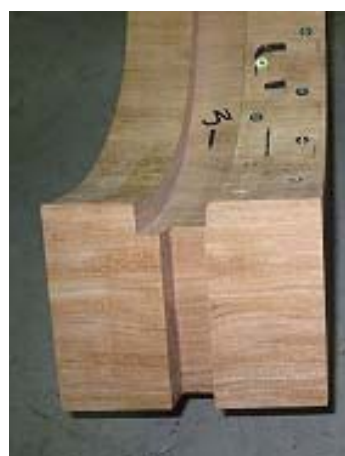
図21 第二期補強部材の損傷(左：ヒノキ、右：アバ)
