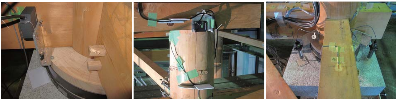
(d) 柱脚の浮き上がり量の計測
