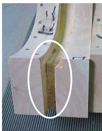
図21 第二期補強部材の損傷(左：ヒノキ、右：アバ)
