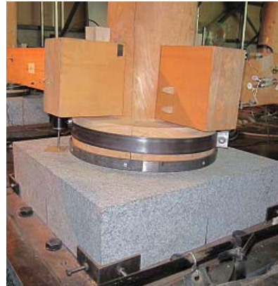
図3 補強部材の取り付け状況
