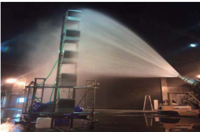
図 5 散水量測定実験
