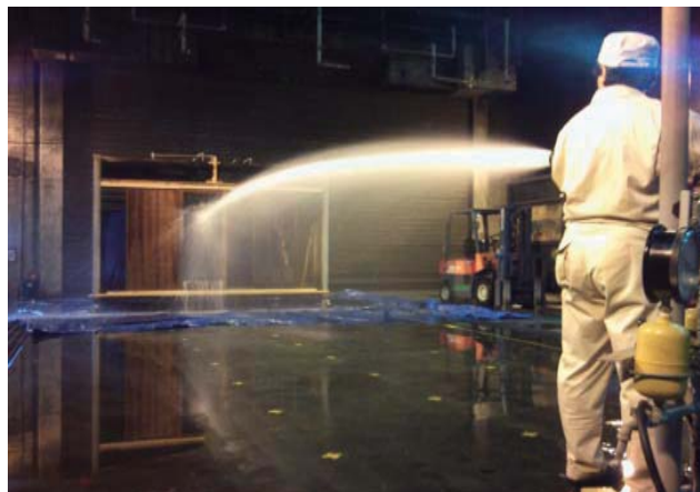
図4 建具まわりに対する散水実験
