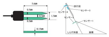
図 5 土中水分計の形状・寸法 図 6 土中水分計の設置状況
