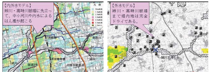
図5 内外水を考慮した氾濫解析結果と外水のみでの氾濫解析結果の違い
