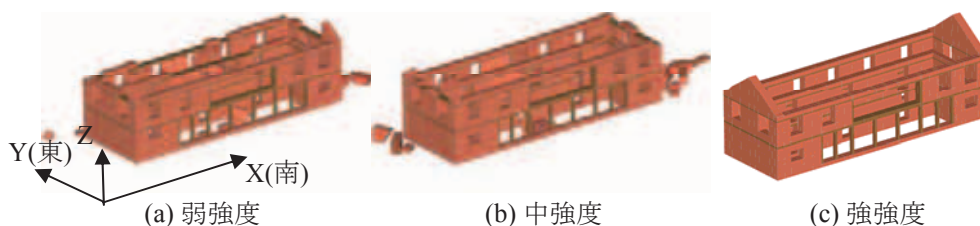
図5 煉瓦要素間強度と建物被害の関係 (50年発生確率:5%、ケースXYZ、リング梁の物性値:煉瓦)
