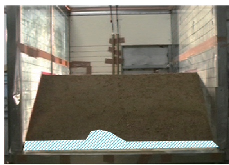
(a) 注水後約 23 分経過（のり先に水が浸潤）
