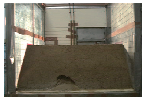
(b) 注水後約 28 分経過（のり先が崩壊）
