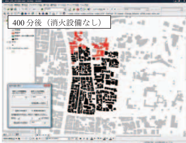
図7 消火設備が機能したかどうかによる延焼動態の比較 (■：燃え尽き、■：燃焼中、■：未燃焼、■：消火中)
