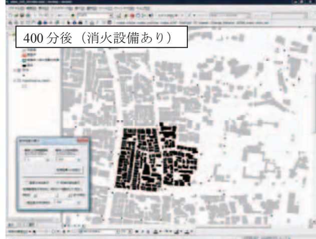
図7 消火設備が機能したかどうかによる延焼動態の比較 (■：燃え尽き、■：燃焼中、■：未燃焼、■：消火中)
