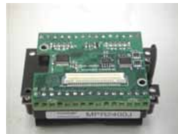
写真1 気象観測用基板と 写真2 外部センサ接続用基板と センサノード センサノード
