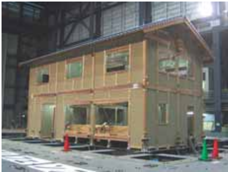
図1 振動台上のA棟外観
