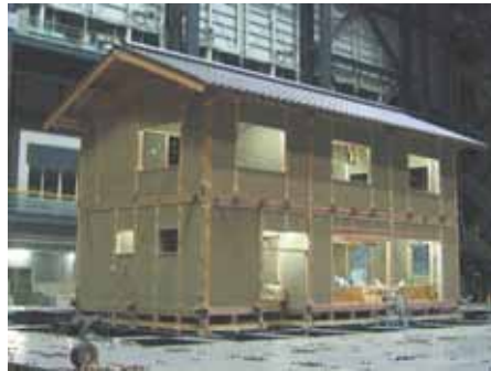
図2 振動台上のB棟外観
