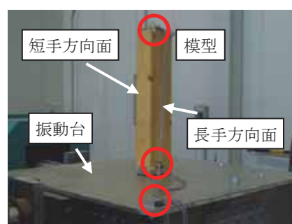
写真3 3次元振動台、模型および加速度計設置箇所
