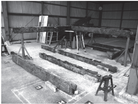
写真7 崩落した軸組の再現状況
