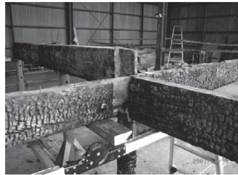
写真8 小黒柱を中心とした梁の仕口部分
