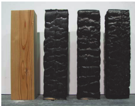
写真11 各燃焼時間の木材試験体(120mm角)の状況
