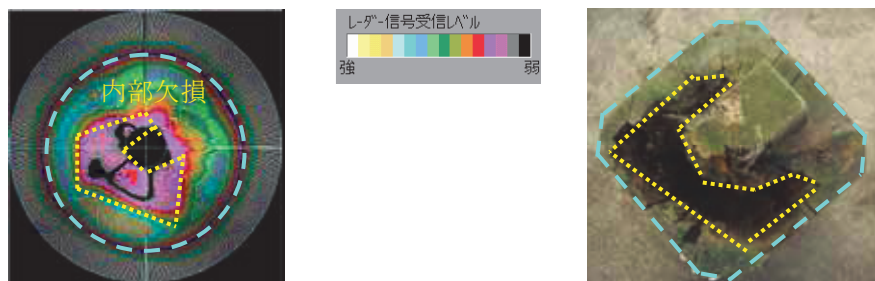
図12 奥の院の劣化柱を用いた実験結果
