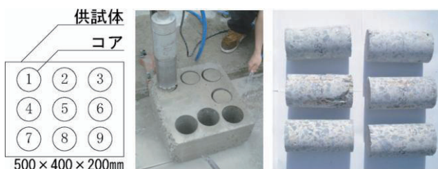
図 1 1 供試体から得られるコア抜きサンプル
