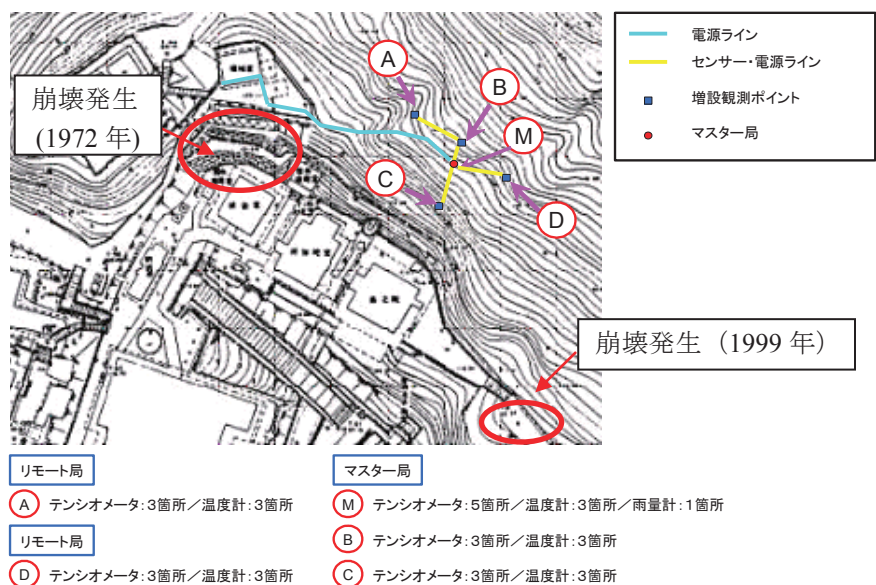
図2 多点現地計測システムの設置位置
