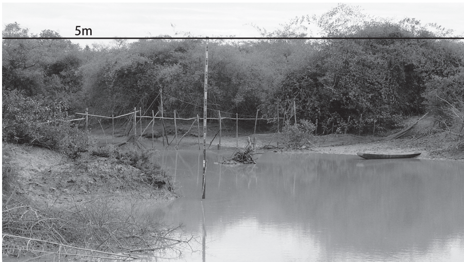
第5図 マークヒヤウ川に設置した水位計
