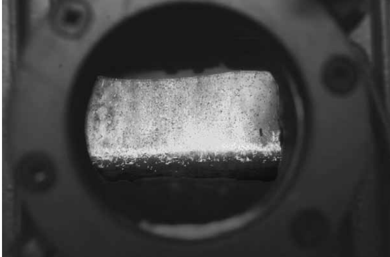
図8：バイオマス発電での炉内の燃焼の様子
