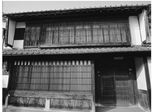
写真1 糸屋格子と延焼防止の袖壁が残るかつての商家 (2015. 2. 23 宮津市内にて筆者撮影)
