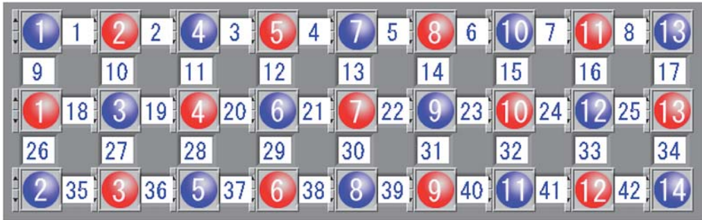
図1 ブローキャップと各ブローブ配置 (青1が被験者の右上で青14が左下)
