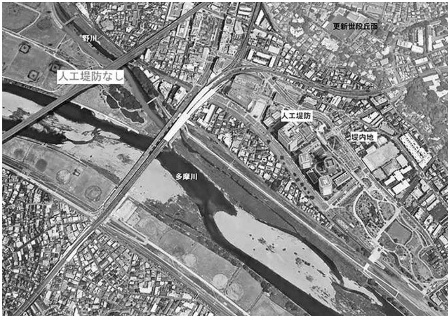
図 12 二子玉川破堤地（野川と多摩川合流地点に人工堤防が築かれていない）
