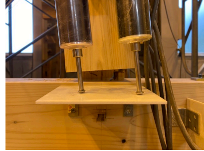
写真 2 柱脚ほぞの折損 (ダンパー 4 試験体)
