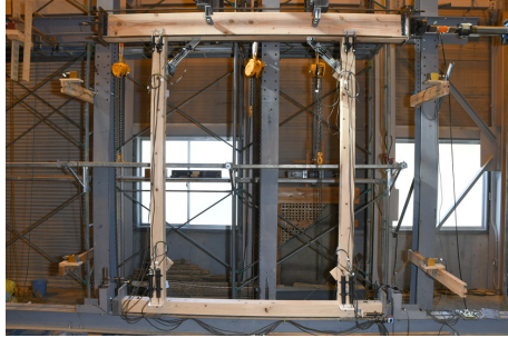
写真 1 ダンパー 2 試験体の設置状況
