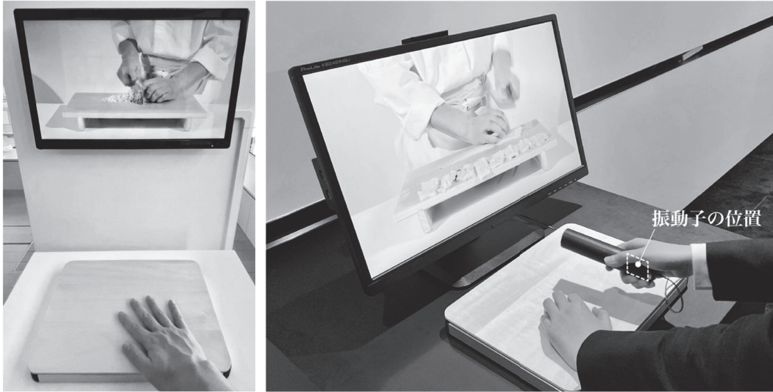
図 2：(左)《調理の振動》(NTT コミュニケーション科学基礎研究所+立命館大学, 2021) を体験する様子、 (右) テーブル型振動提示装置とシリンダー型振動提示装置を同時体験する様子
