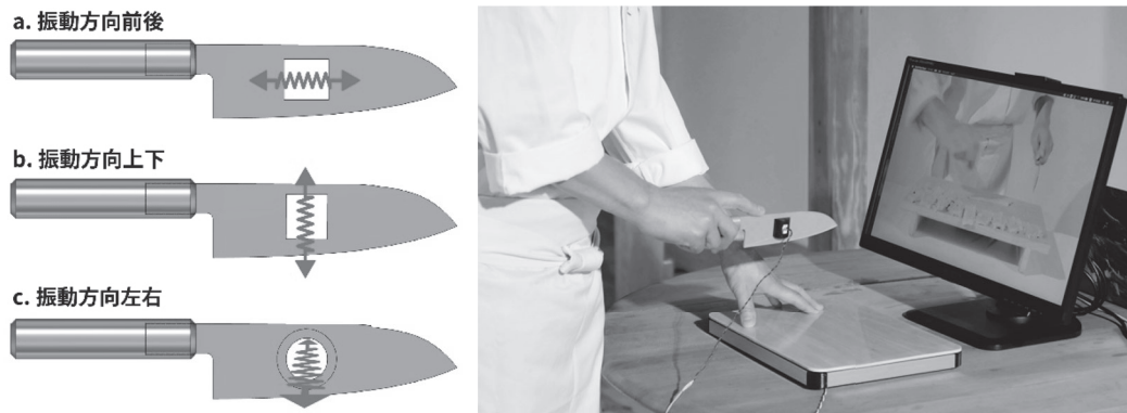
図3：(左) 振動子の取り付け方による振動方向の検証、(右) 改善された体験構成のデバイス
