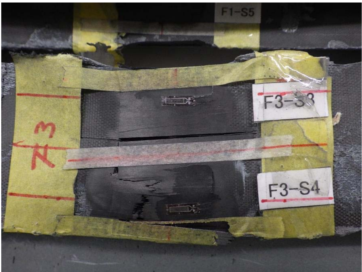
写真-付 4.27 曲げ載荷試験後における CFRP の破壊状況 (試験体 F-b 幅方向 表)
