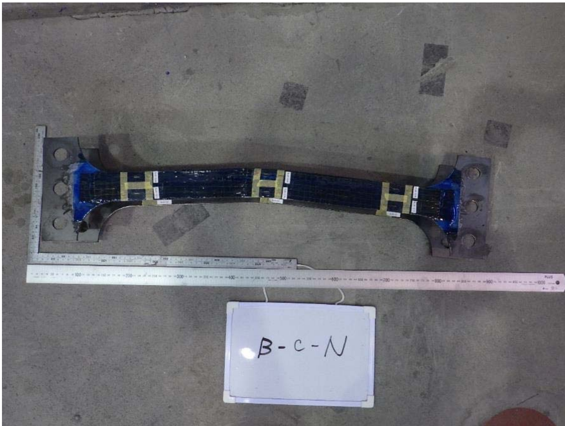
写真-付 6.19 圧縮試験後の試験体（試験体 B-c-N）（その 1）
