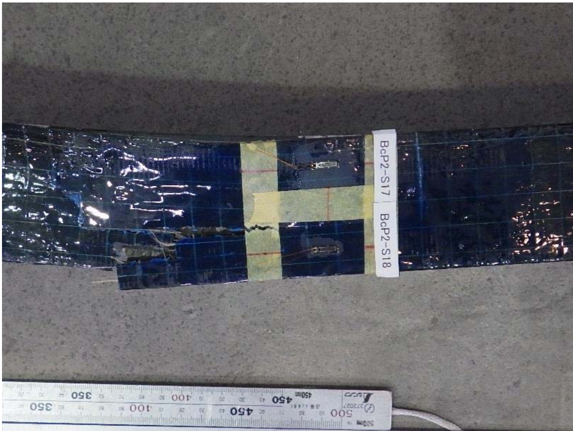
写真-付 6.27 圧縮試験後の試験体（試験体 B-c-P2）（その 3）
