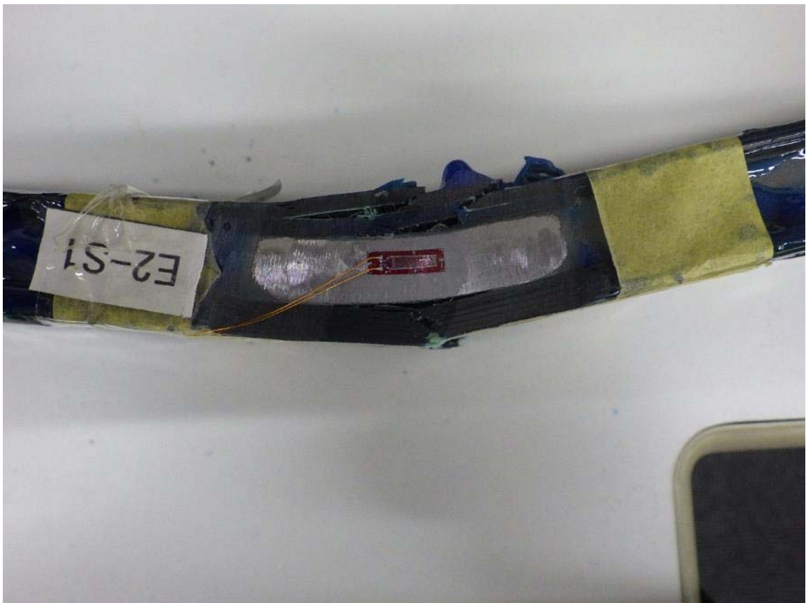
写真-付 4.14 圧縮載荷試験後における CFRP の破壊状況 (試験体 E-c 板厚方向 圧縮→引張側)
