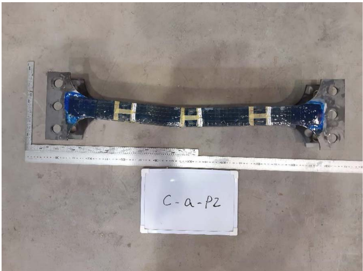
写真-付 6.58 交番载荷試験後の試験体（試験体 C-a-P2）（その 2）
