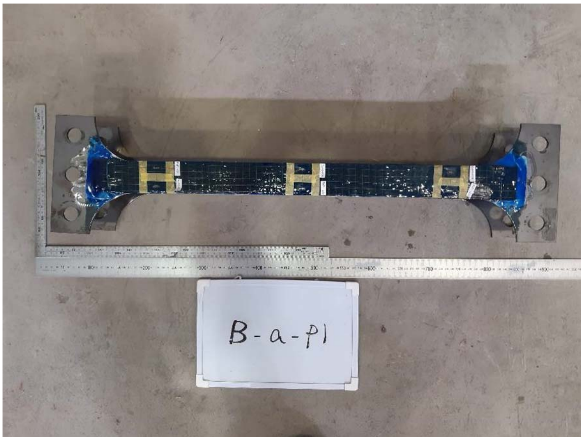
写真-付 6.44 交番载荷試験後の試験体 (試験体 B-a-P1) (その 2)
