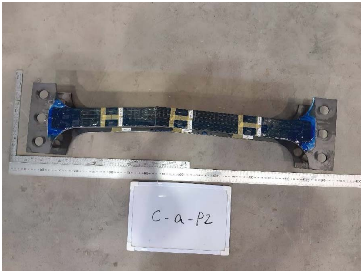
写真-付 6.57 交番载荷試験後の試験体（試験体 C-a-P2）（その 1）
