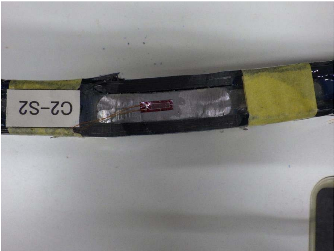
写真-付 4.7 圧縮載荷試験後における CFRP の破壊状況 (試験体 C-c 板厚方向 圧縮→引張側)
