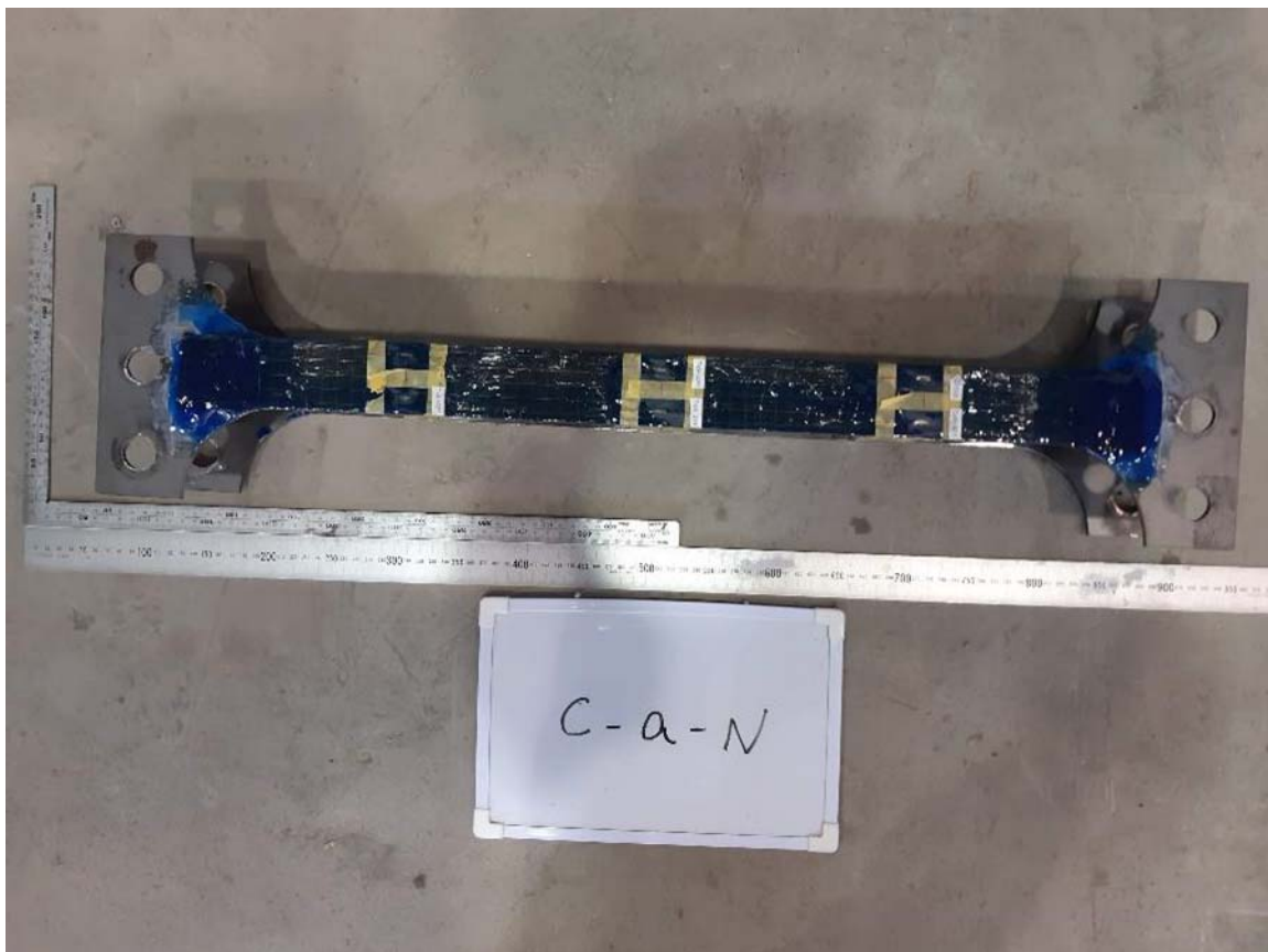
写真-付 6.50 交番载荷試験後の試験体 (試験体 C-a-N) (その 2)
