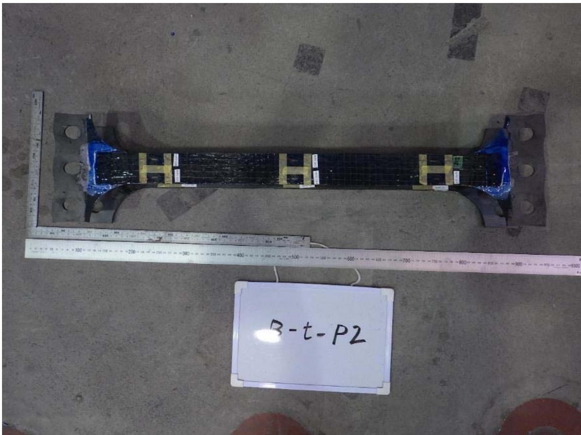
写真-付 6.10 引張試験後の試験体（試験体 B-t-P2）（その 2）
