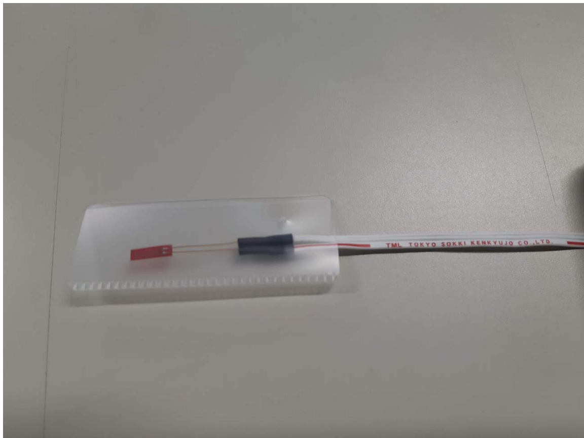
写真-付 4.1 ひずみゲージ (FLAB-5-11-5LQM-F)
