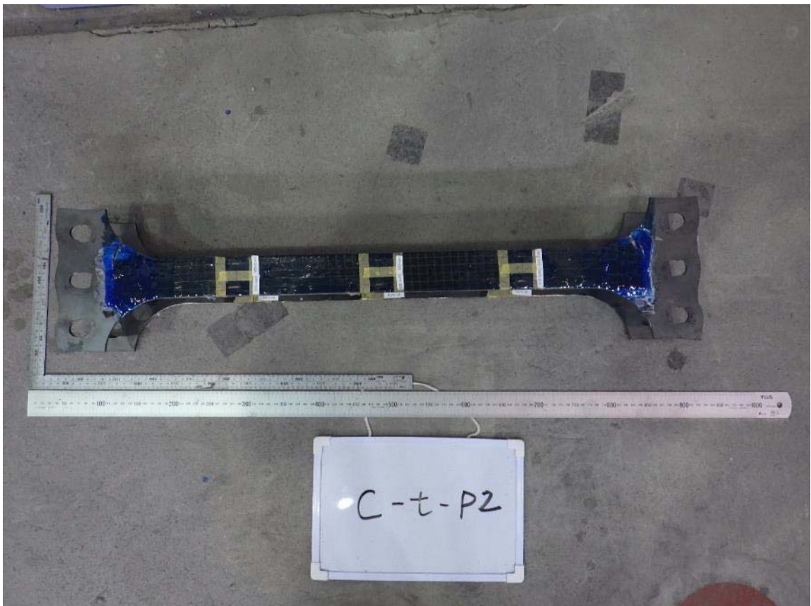
写真-付 6.16 引張試験後の試験体（試験体 C-t-P2）（その 2）
