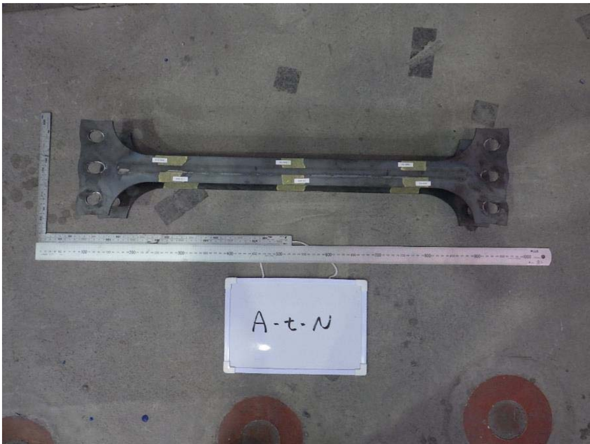
写真-付 6.6 引張試験後の試験体（試験体 A-t-N）（その 2）
