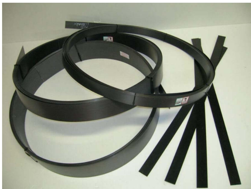
写真-2.3 CFRP プレート
