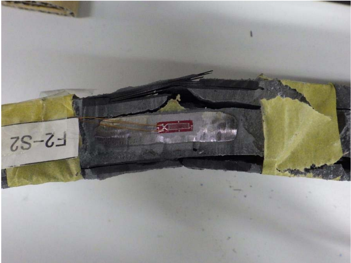
写真-付 4.19 圧縮載荷試験後における CFRP の破壊状況（試験体 F-c 板厚方向 引張→圧縮側）
