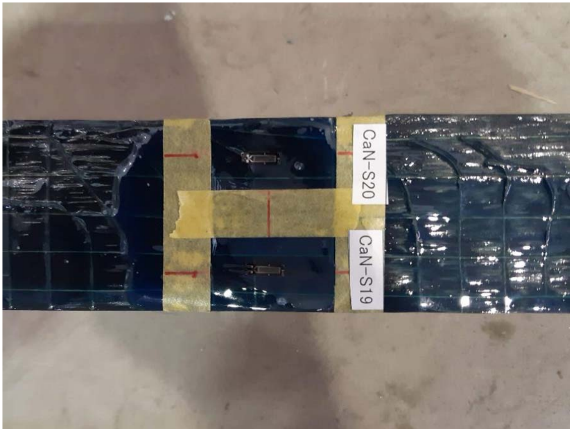
写真-付 6.52 交番载荷試験後の試験体 (試験体 C-a-N) (その 4)
