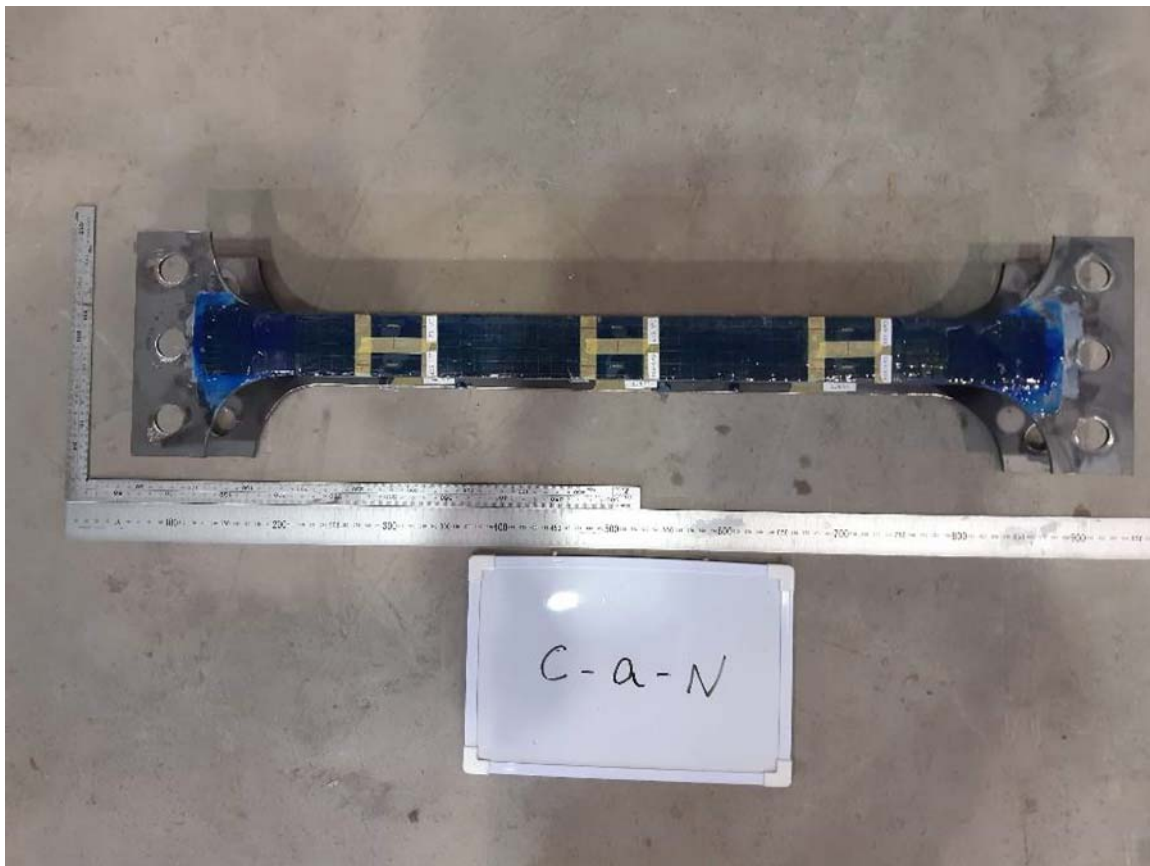
写真-付 6.49 交番载荷試験後の試験体 (試験体 C-a-N) (その 1)
