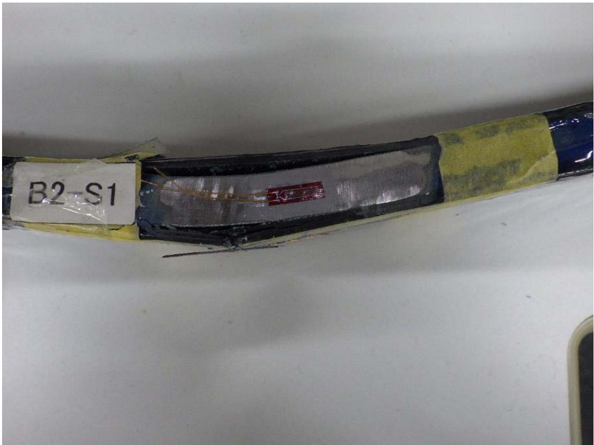
写真-4.9 圧縮荷重試験後における CFRP の破壊状況 (試験体 B-c 板厚方向 圧縮→引張側)
