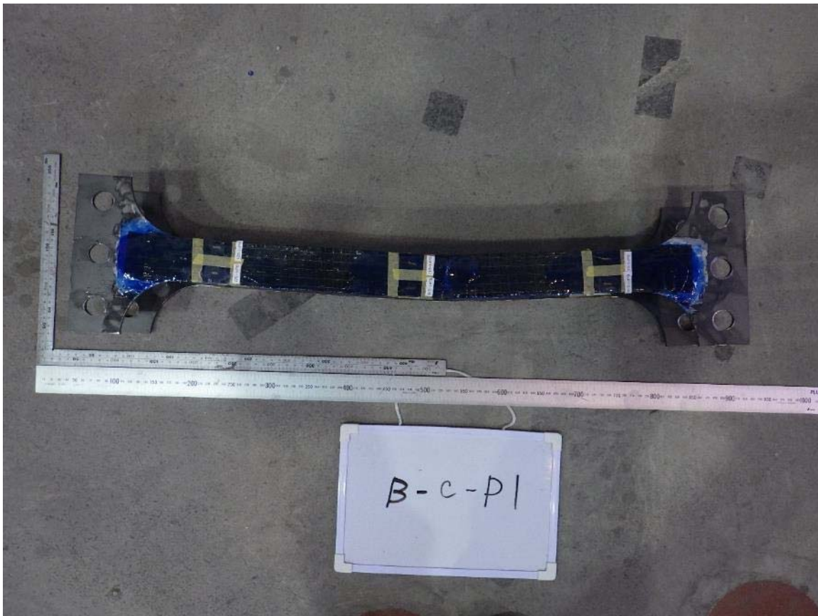
写真-付 6.21 圧縮試験後の試験体（試験体 B-c-P1）（その 1）
