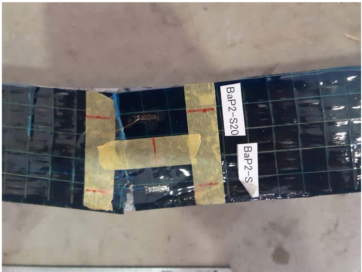
写真-付 6.48 交番载荷試験後の試験体（試験体 B-a- P2）（その 2）
