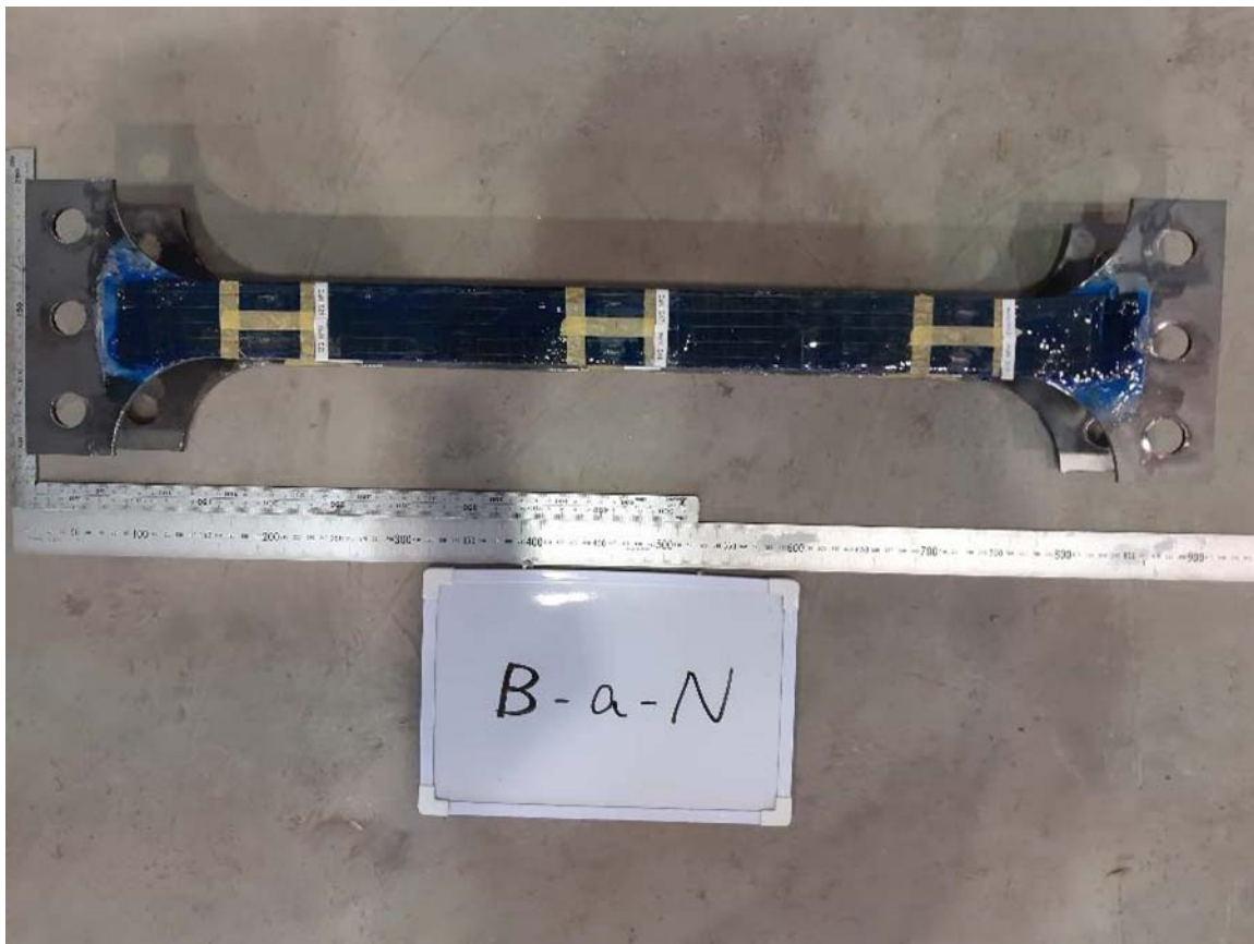
写真-付 6.39 交番载荷試験後の試験体（試験体 B-a-N）（その 1）
