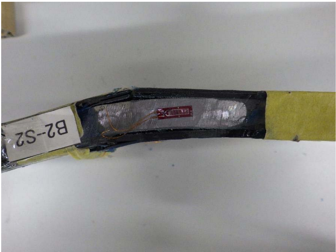
写真-4.10 圧縮荷重試験後における CFRP の破壊状況 (試験体 B-c 板厚方向 引張→圧縮側)
