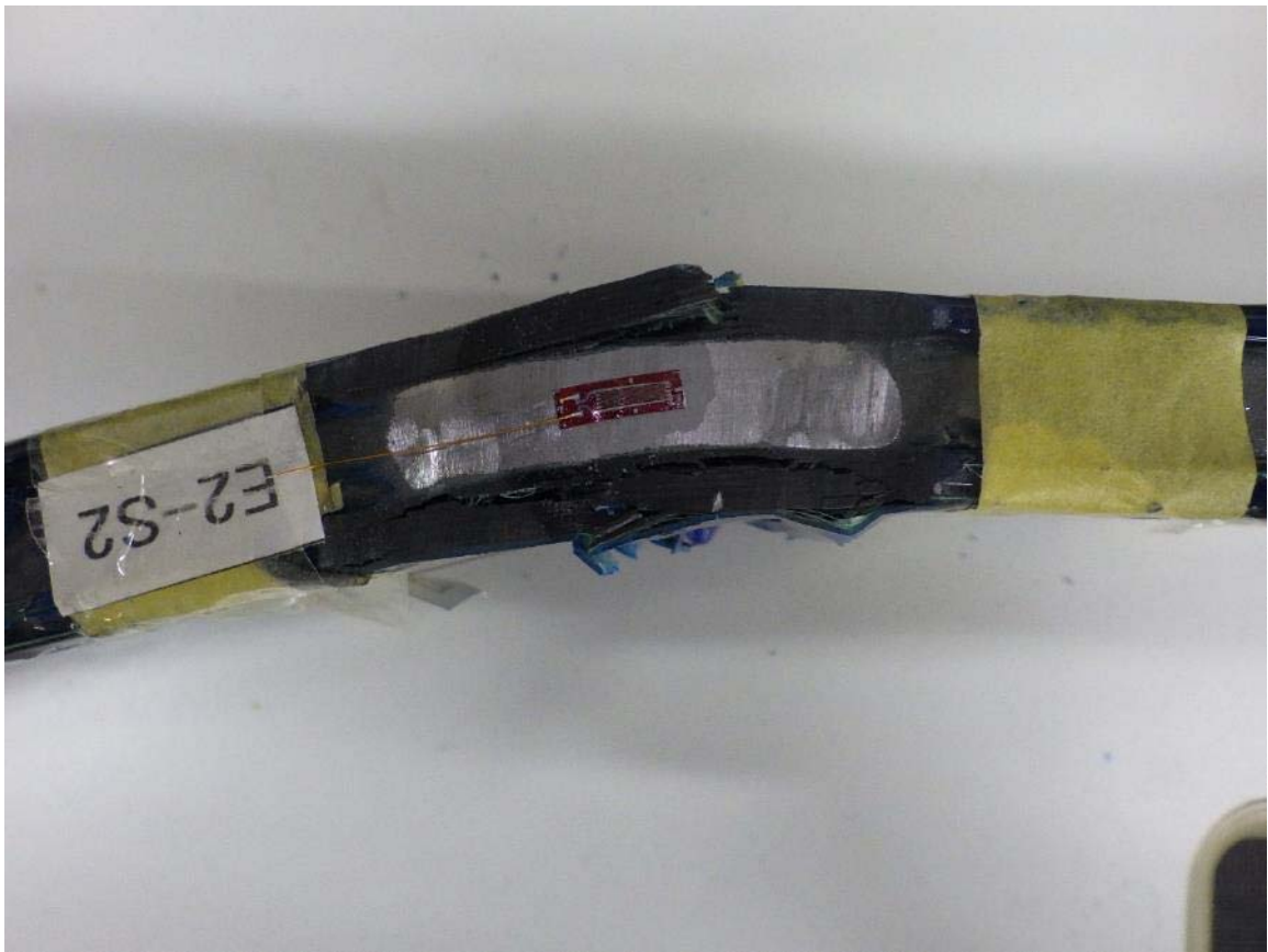
写真-付 4.15 圧縮載荷試験後における CFRP の破壊状況 (試験体 E-c 板厚方向 引張→圧縮側)
