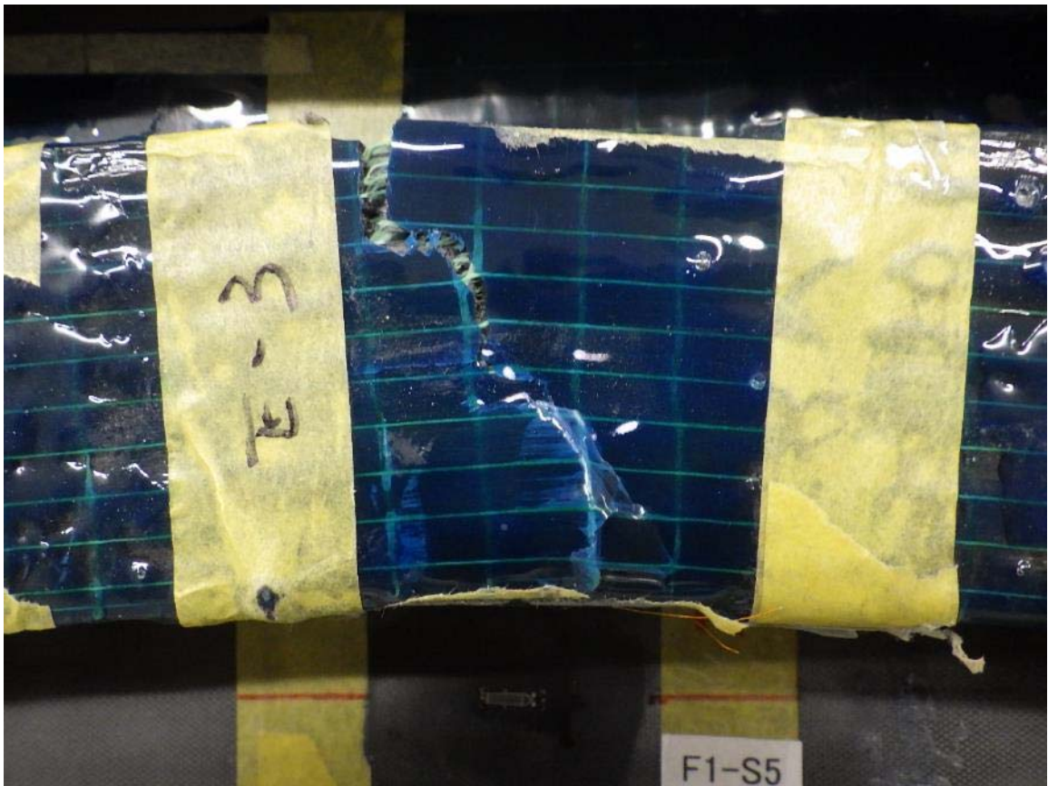
写真-付 4.26 曲げ載荷試験後における CFRP の破壊状況 (試験体 E-b 幅方向 裏)
