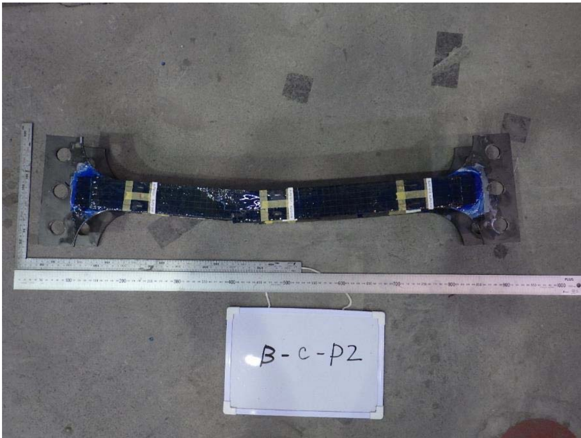
写真-付 6.25 圧縮試験後の試験体（試験体 B-c-P2）（その 1）
