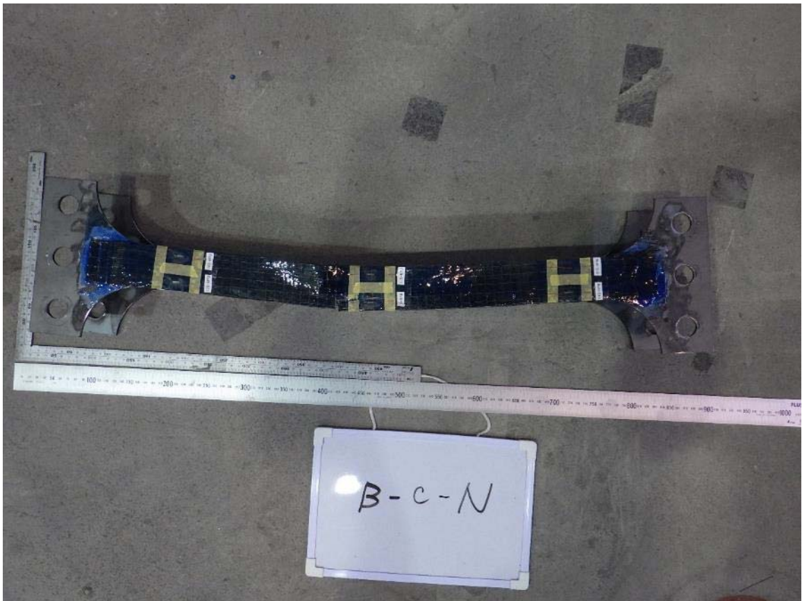
写真-6.5 圧縮試験後の試験体（試験体 B-c-N）（その 1）
