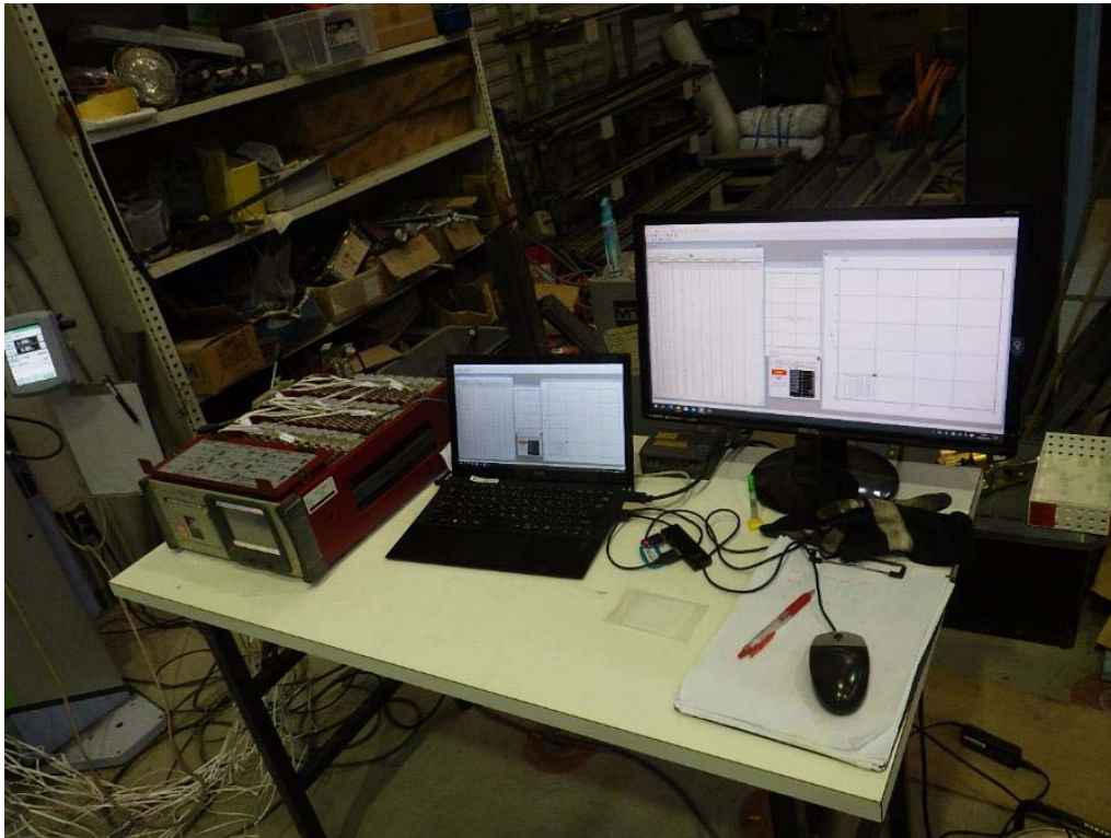
写真-6.2 データロガー（TDS-530）およびパソコンの接続状況
