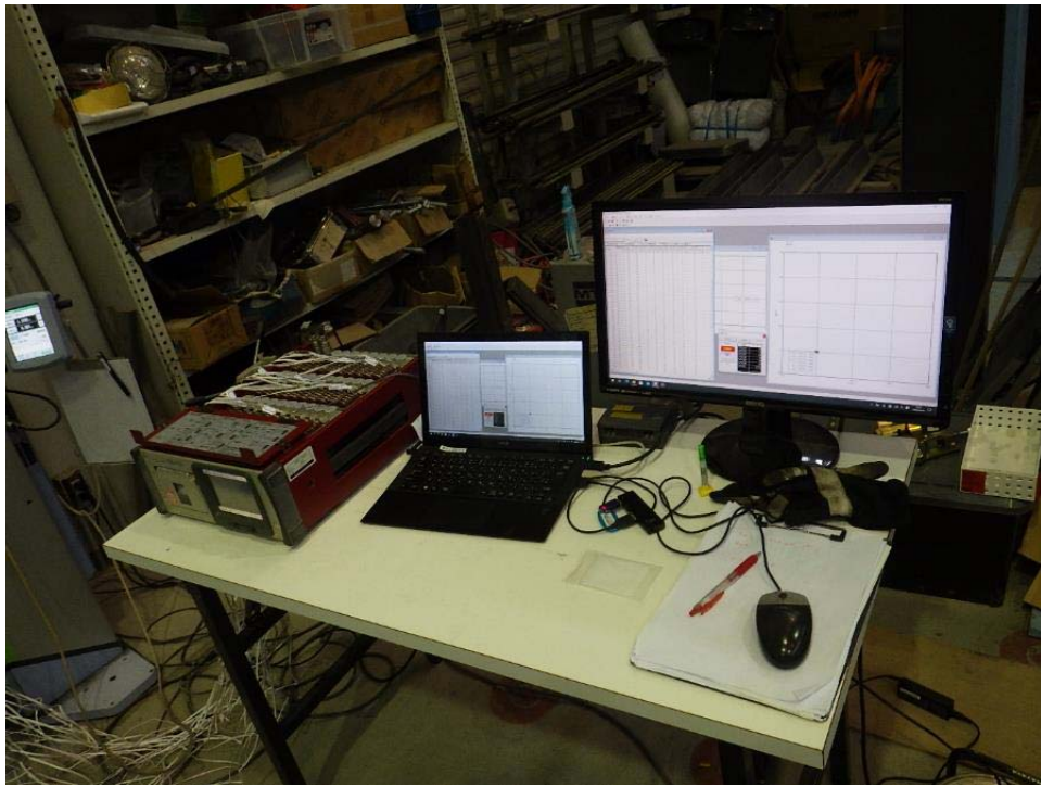
写真-4.4 データロガー（TDS-530）およびパソコンの接続状況
