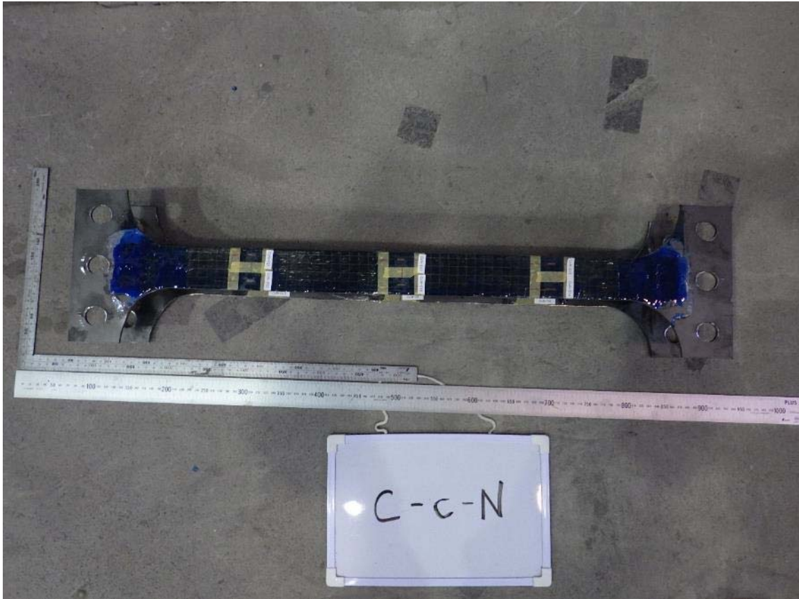
写真-付 6.29 圧縮試験後の試験体（試験体 C-c-N）（その 1）
