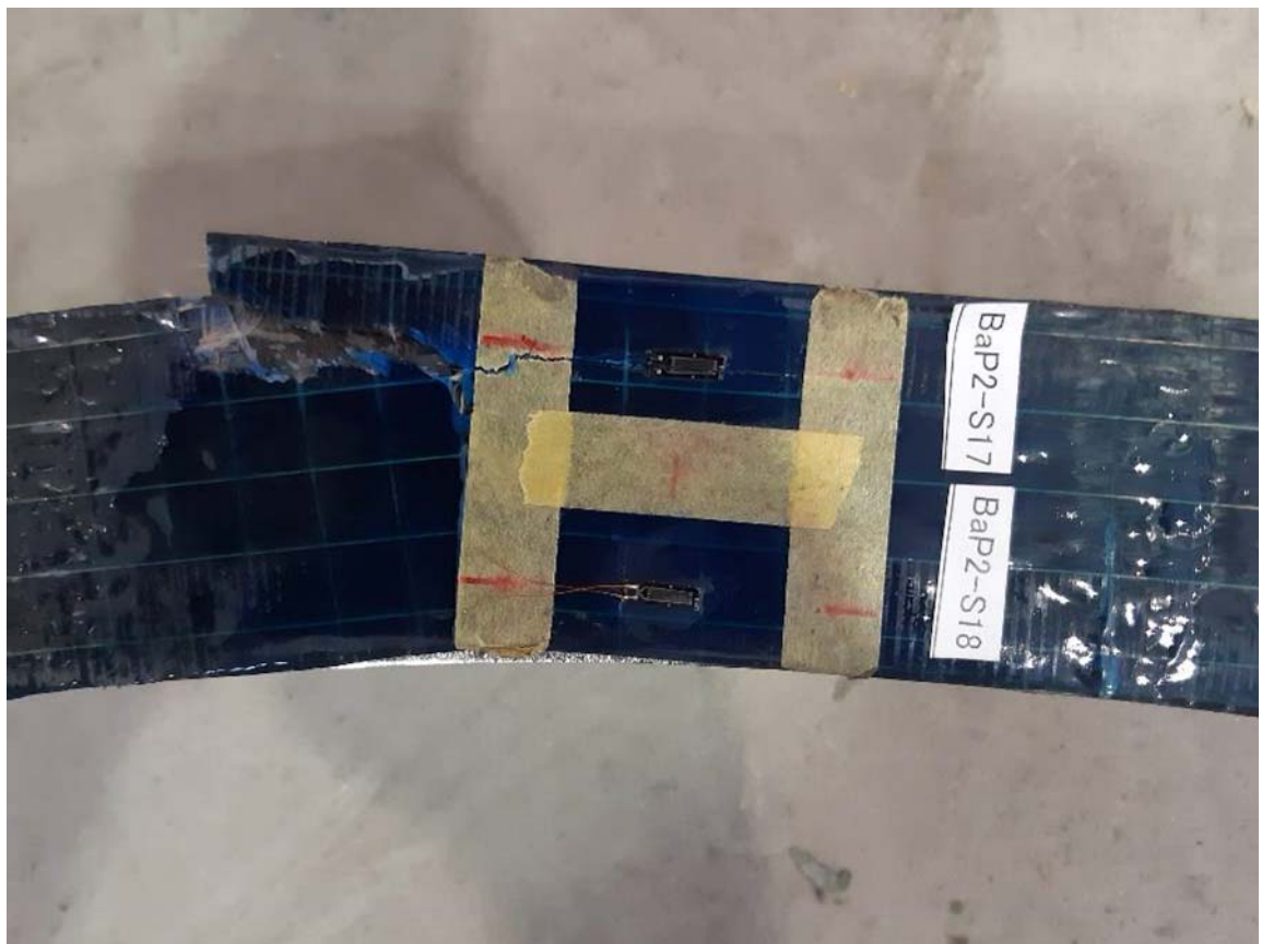
写真-6.8 交番载荷試験後の試験体（試験体 B-a-P2）（その 2）
