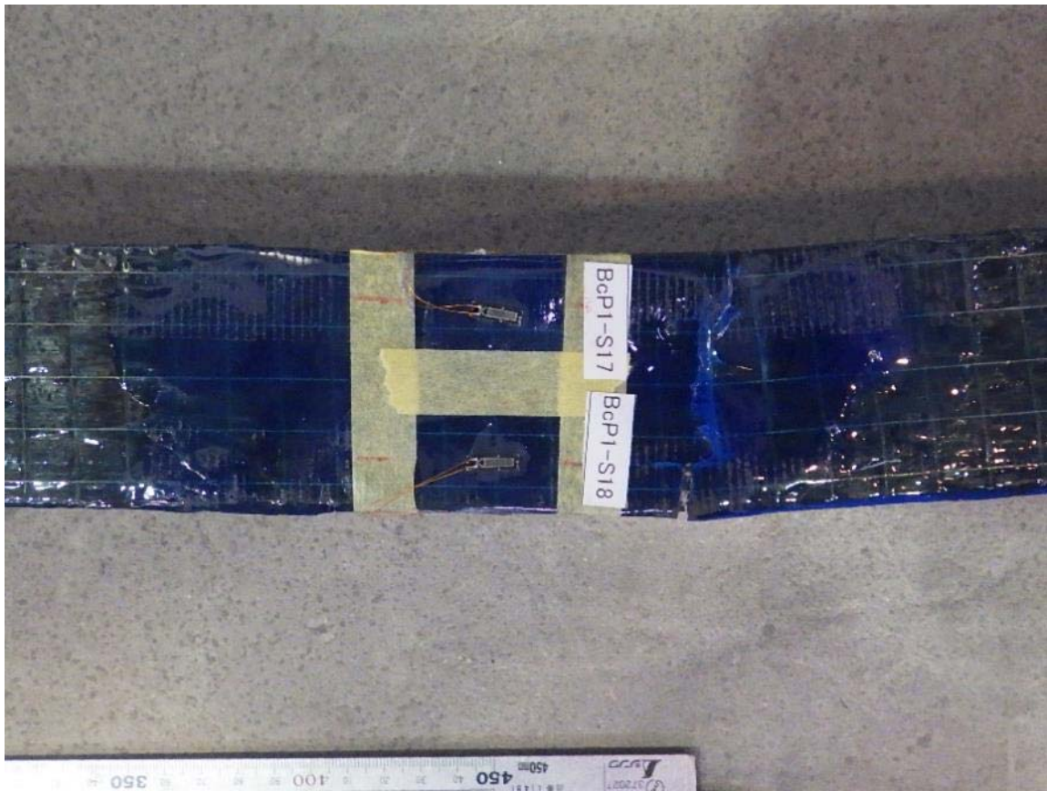
写真-付 6.23 圧縮試験後の試験体（試験体 B-c-P1）（その 3）
