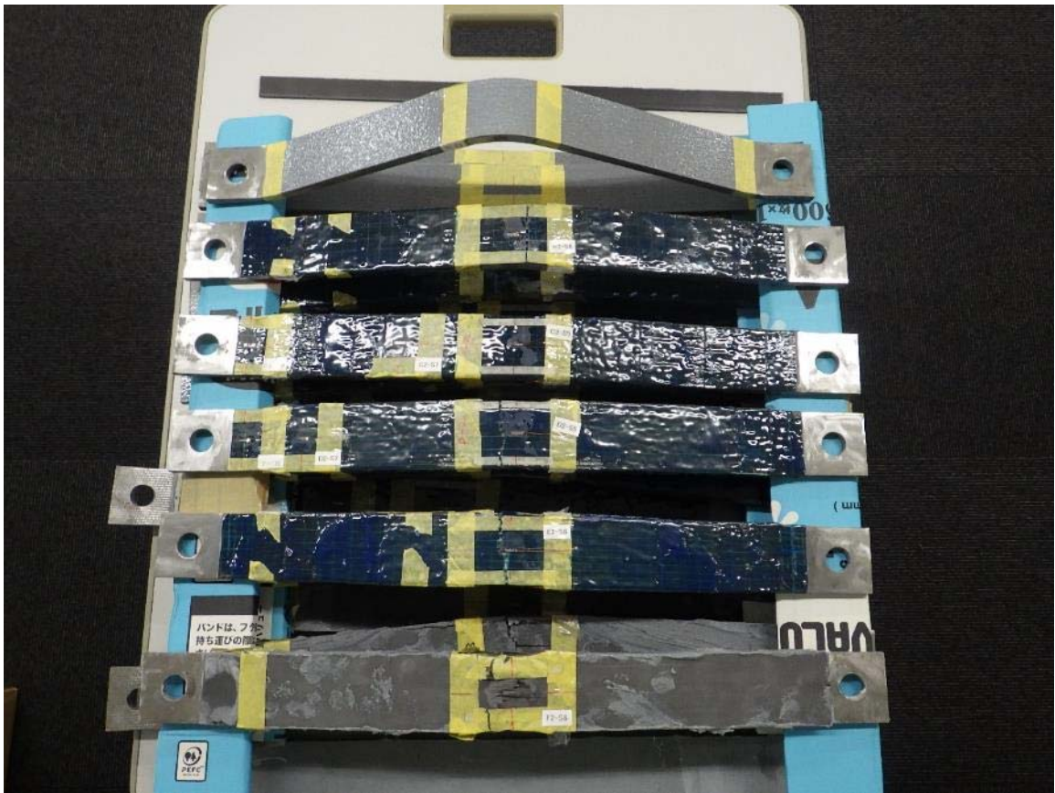
写真-付 4.3 圧縮載荷試験後の試験体
