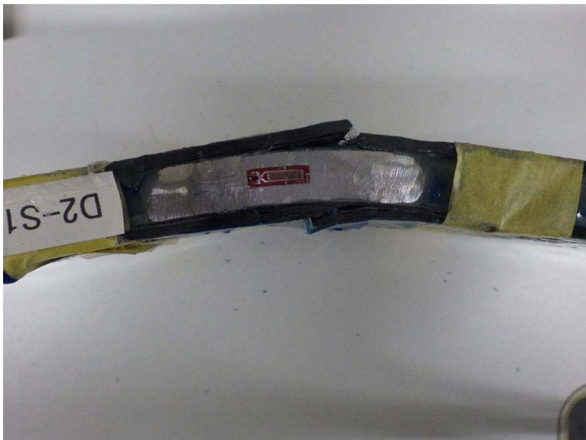
写真-付 4.10 圧縮荷重試験後における CFRP の破壊状況 (試験体 D-c 板厚方向 引張→圧縮側)
