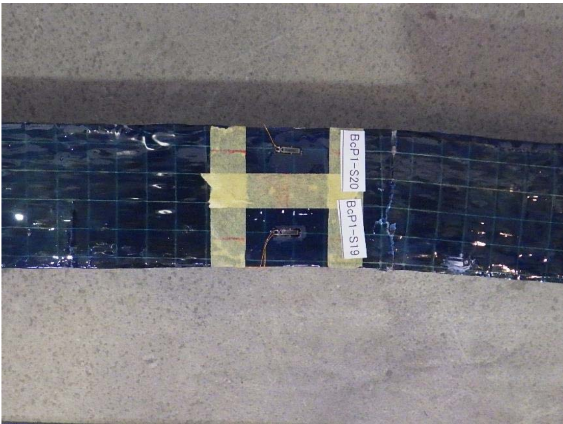
写真-付 6.24 圧縮試験後の試験体（試験体 B-c-P1）（その 4）
