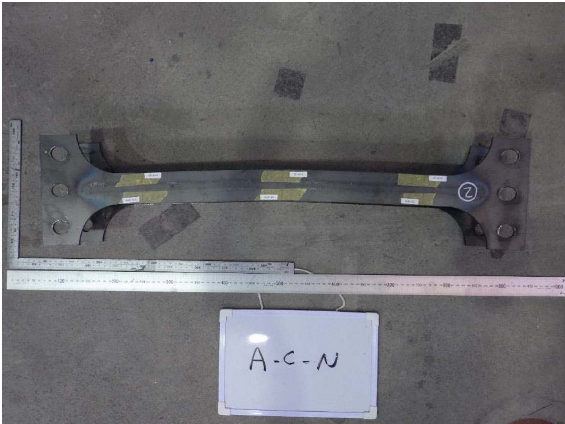
写真-付 6.17 圧縮試験後の試験体（試験体 A-c-N）（その 1）
