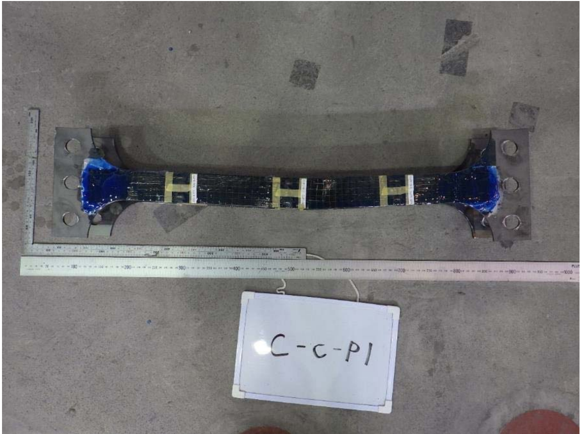
写真-付 6.31 圧縮試験後の試験体（試験体 C-c-P1）（その 1）
