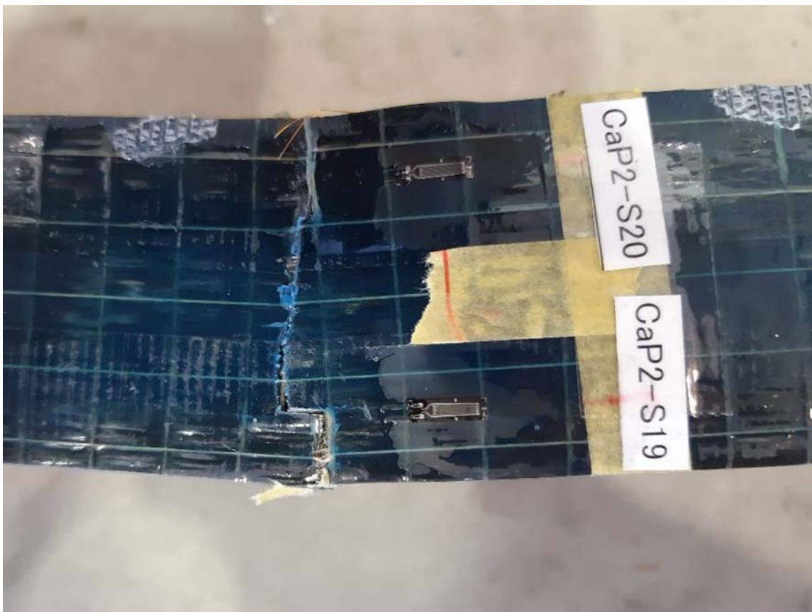
写真-付 6.60 交番载荷試験後の試験体（試験体 C-a- P2）（その 4）
