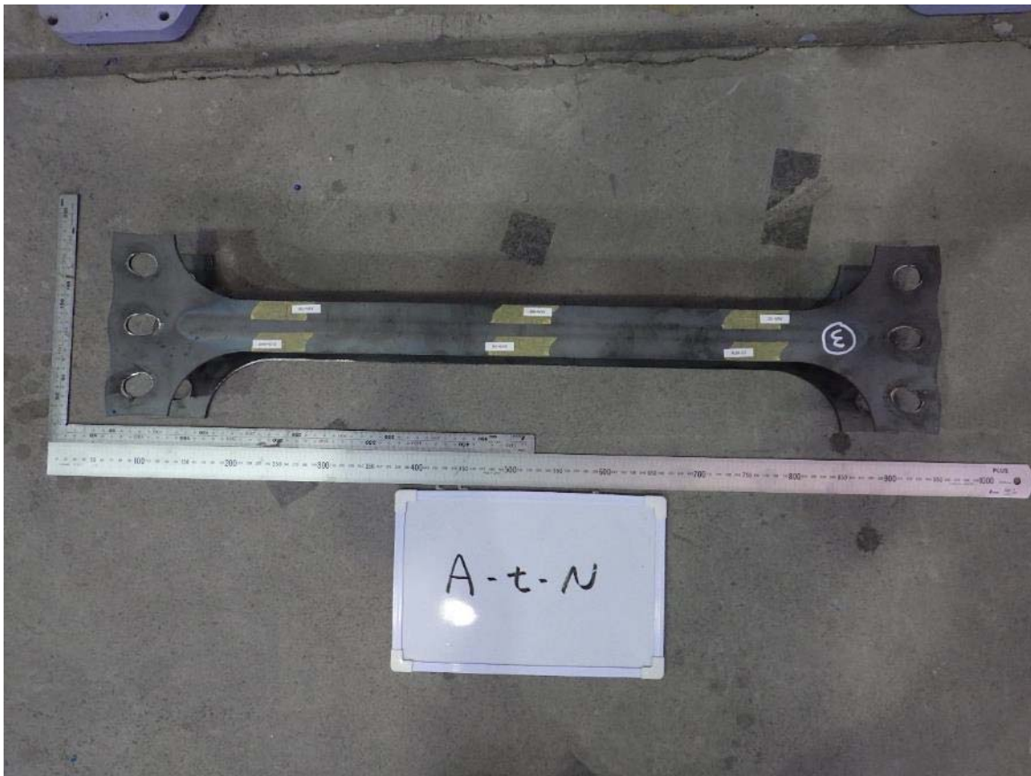
写真付-6.5 引張試験後の試験体（試験体 A-t-N）（その 1）
