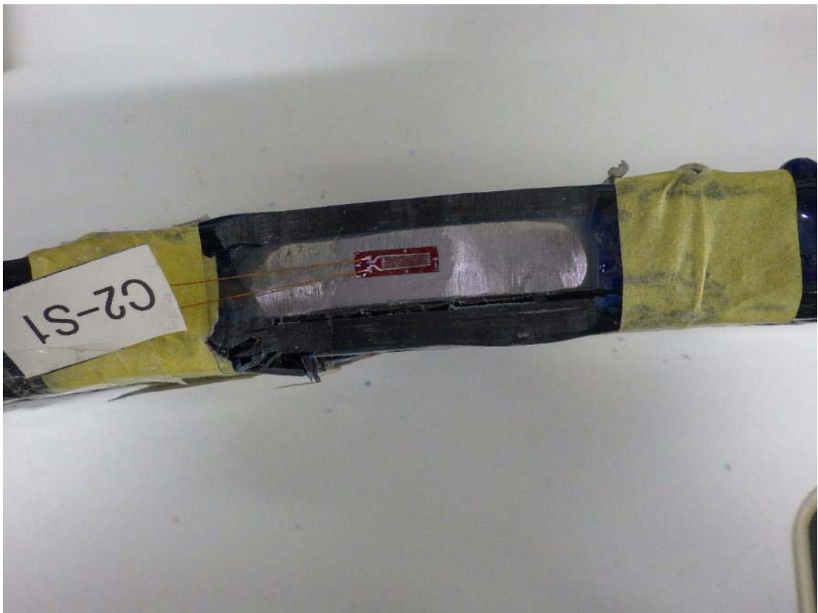
写真-付 4.6 圧縮荷重試験後における CFRP の破壊状況 (試験体 C-c 板厚方向 引張→圧縮側)
