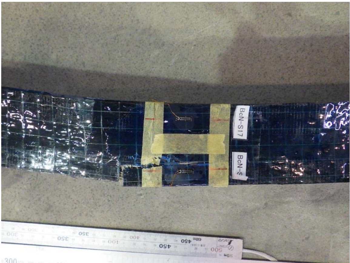
写真-6.6 圧縮試験後の試験体（試験体 B-c-N）（その 2）
