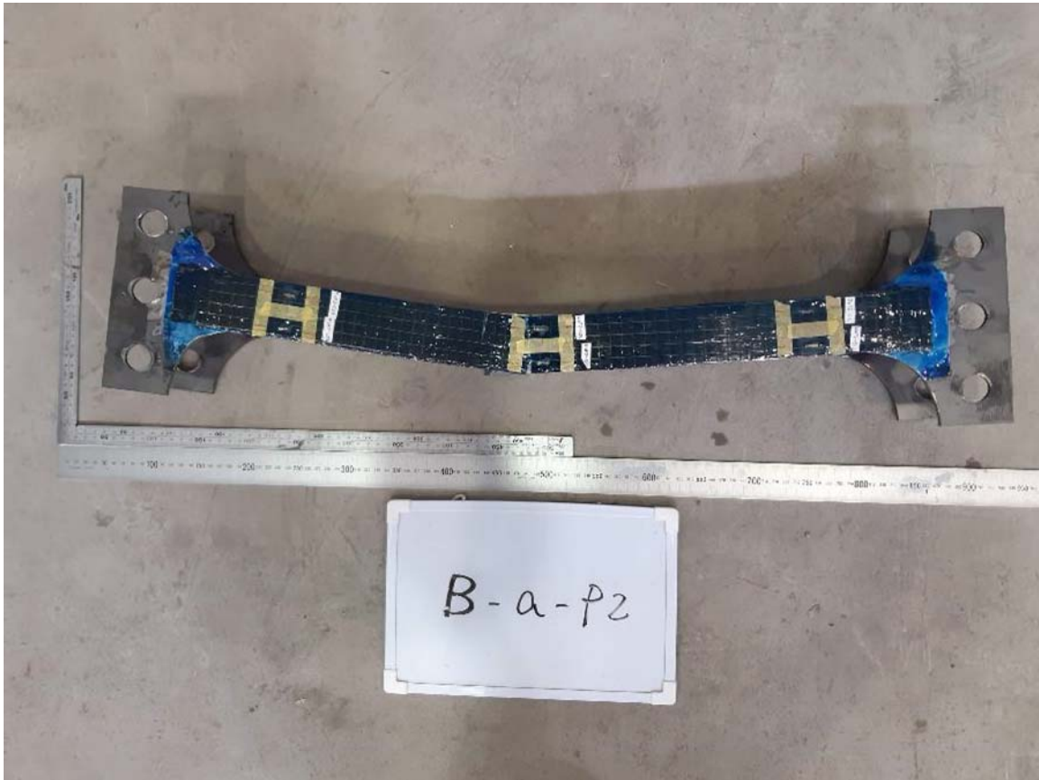
写真付-6.47 交番载荷試験後の試験体（試験体 B-a- P2）（その 1）
