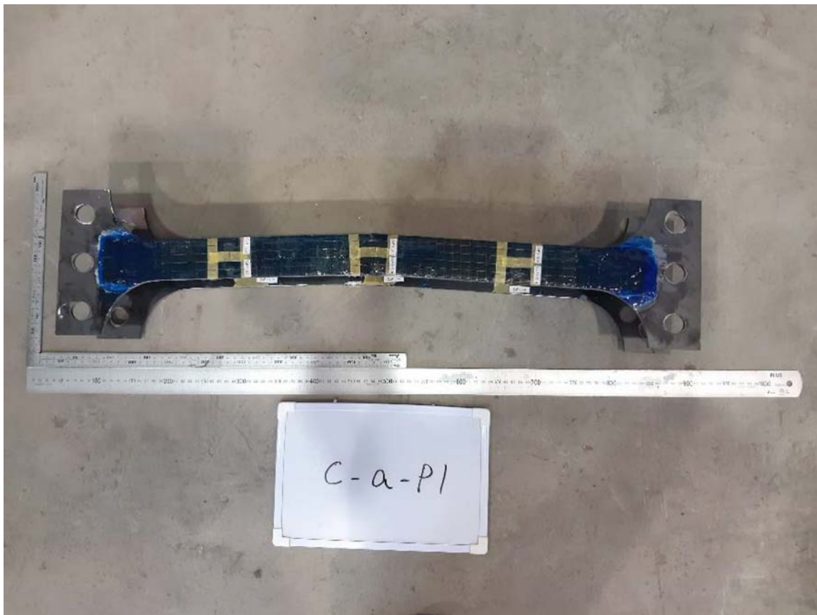
写真-付 6.53 交番载荷試験後の試験体（試験体 C-a-P1）（その 1）
