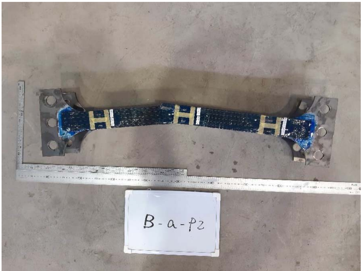
写真-6.7 交番载荷試験後の試験体（試験体 B-a-P2）（その 1）
