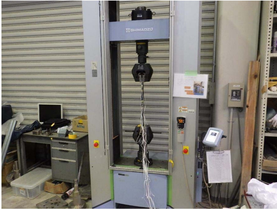
写真-4.1 引張载荷試験の実施状況
