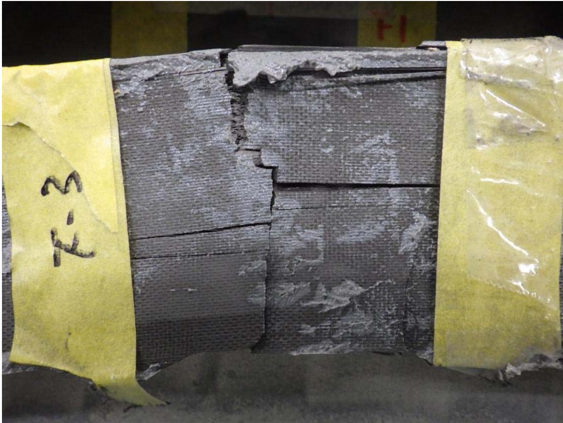
写真-付 4.28 曲げ載荷試験後における CFRP の破壊状況 (試験体 F-b 幅方向 裏)
