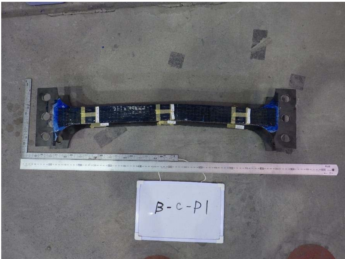
写真-付 6.22 圧縮試験後の試験体（試験体 B-c-P1）（その 2）
