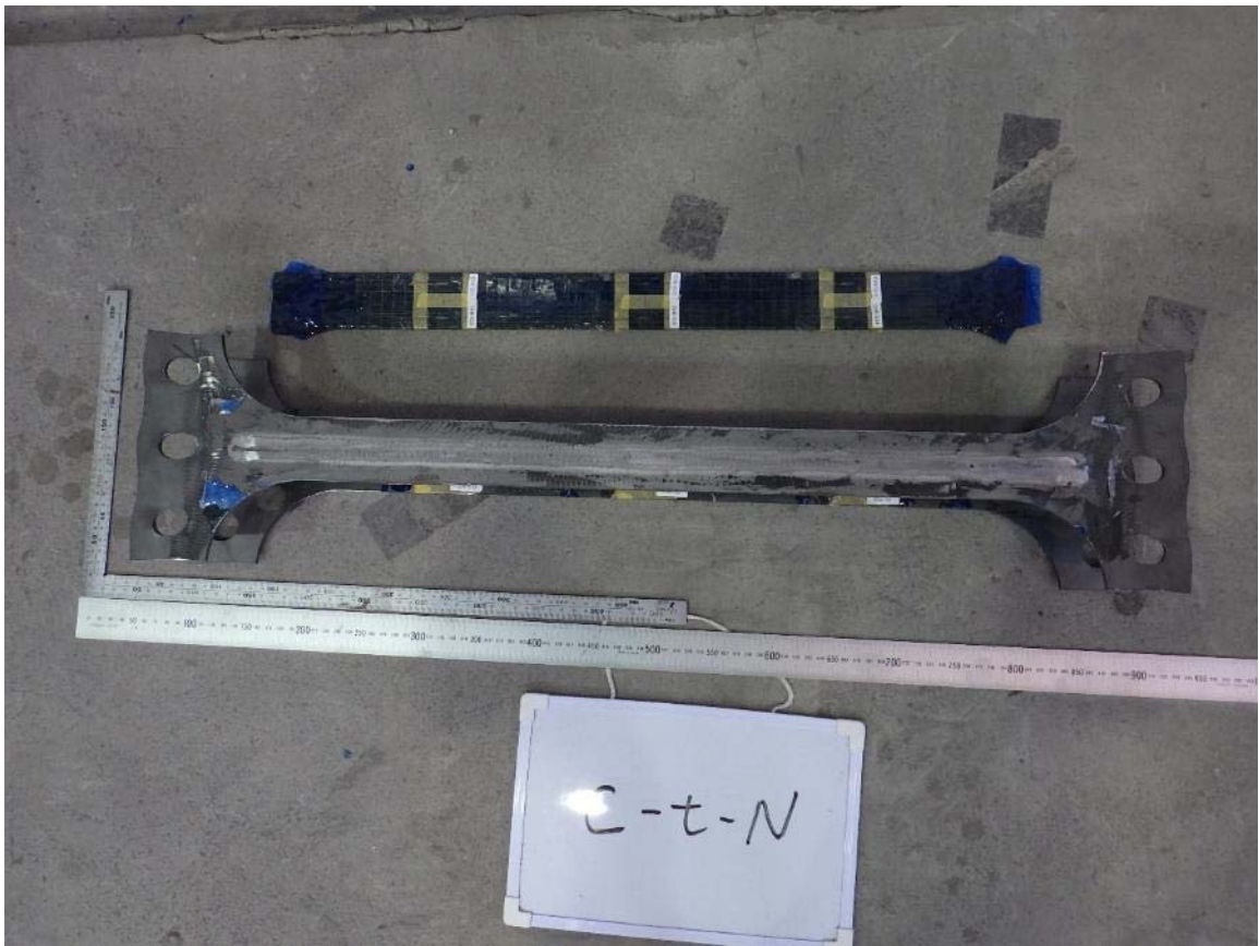
写真-付 6.11 引張試験後の試験体（試験体 C-t-N）（その 1）
