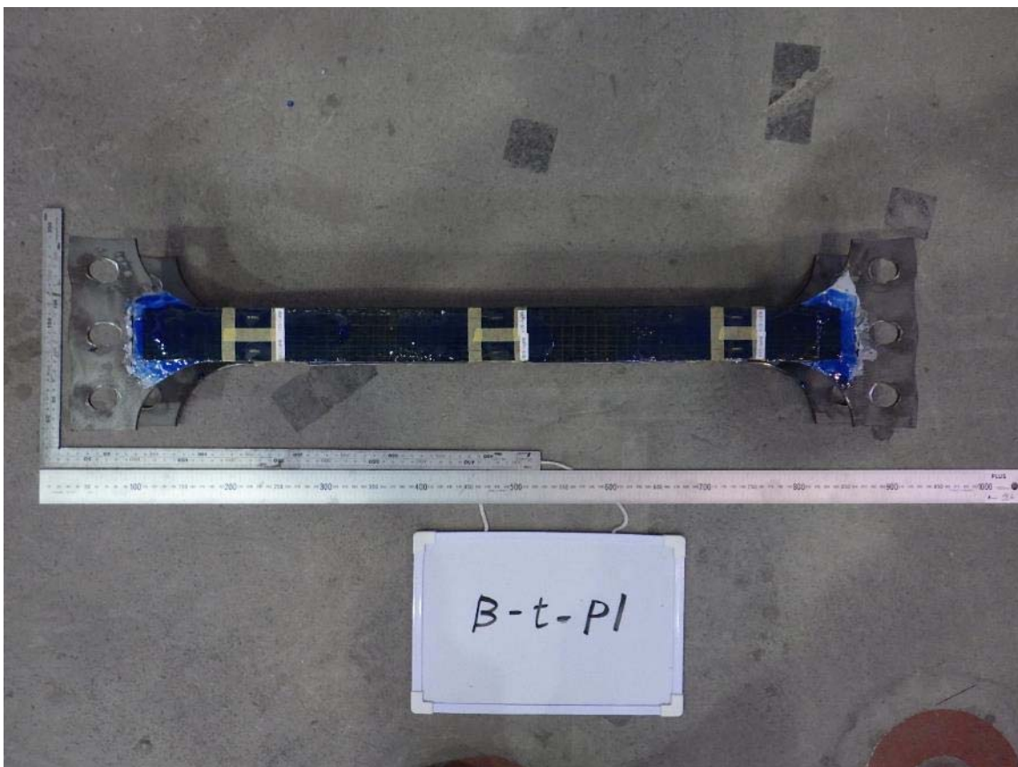
写真-6.4 引張試験後の試験体（試験体 B-t-P1）
