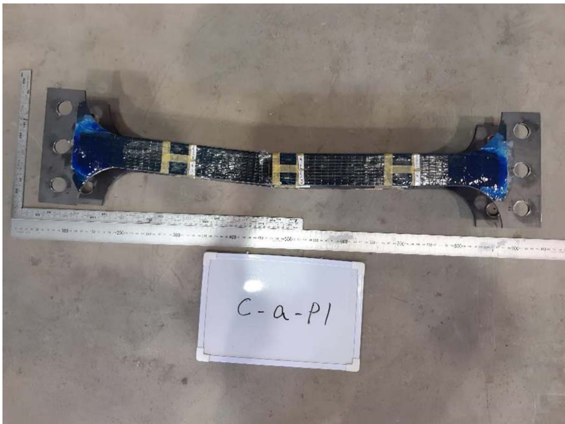
写真-付 6.54 交番载荷試験後の試験体（試験体 C-a-P1）（その 2）
