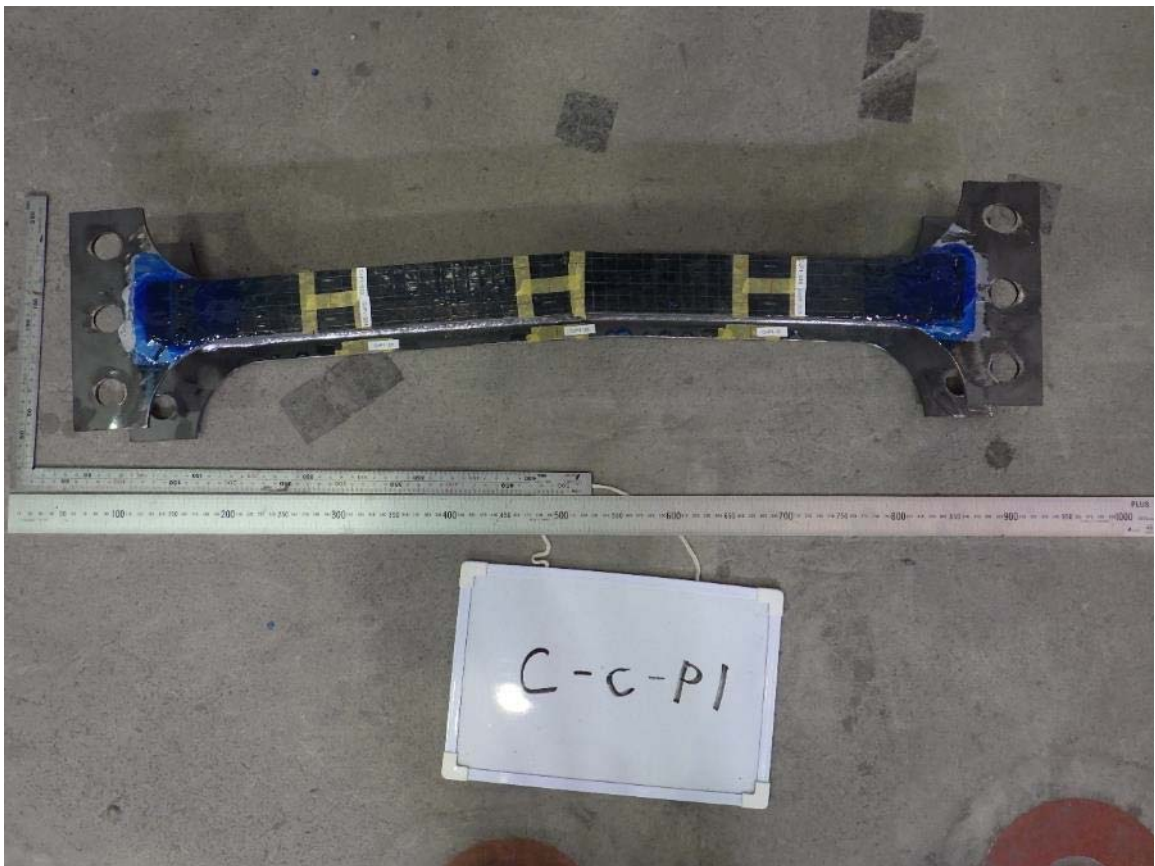
写真-付 6.32 圧縮試験後の試験体（試験体 C-c-P1）（その 2）
