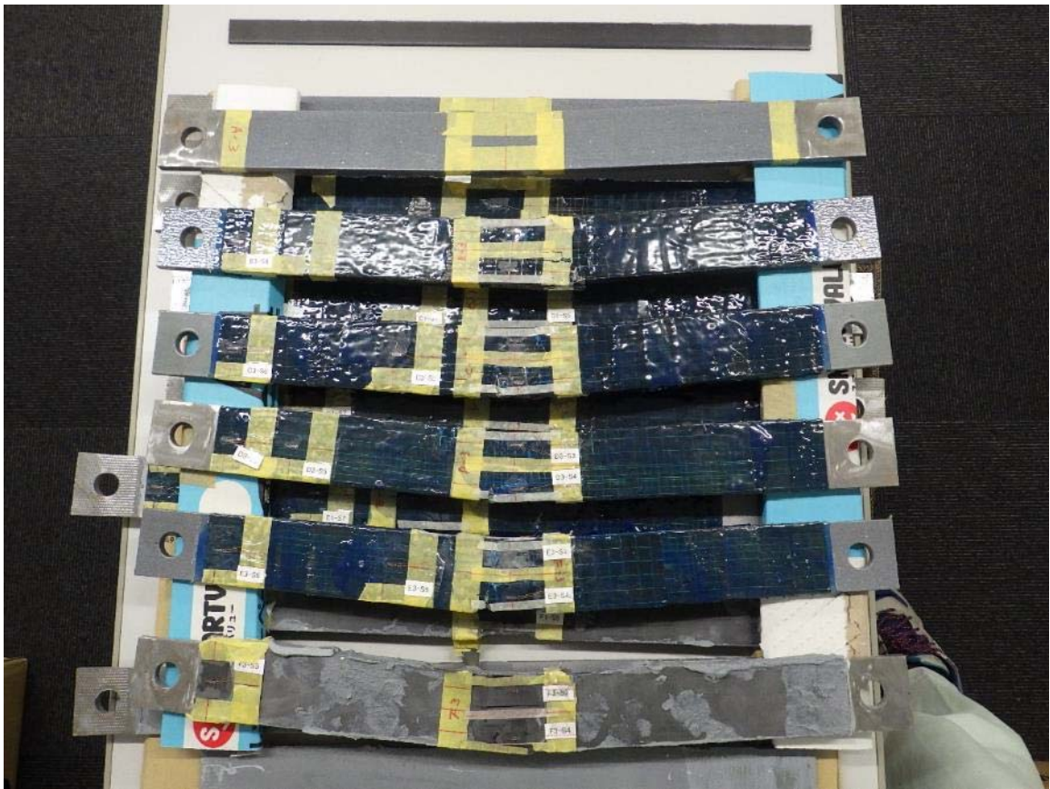
写真-付 4.20 曲げ载荷試験後の試験体
