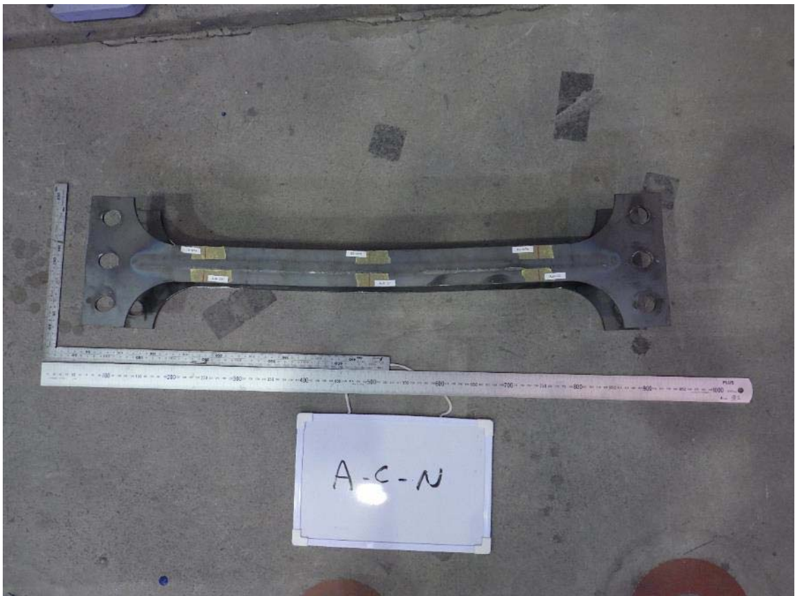
写真-付 6.18 圧縮試験後の試験体（試験体 A-c-N）（その 2）
