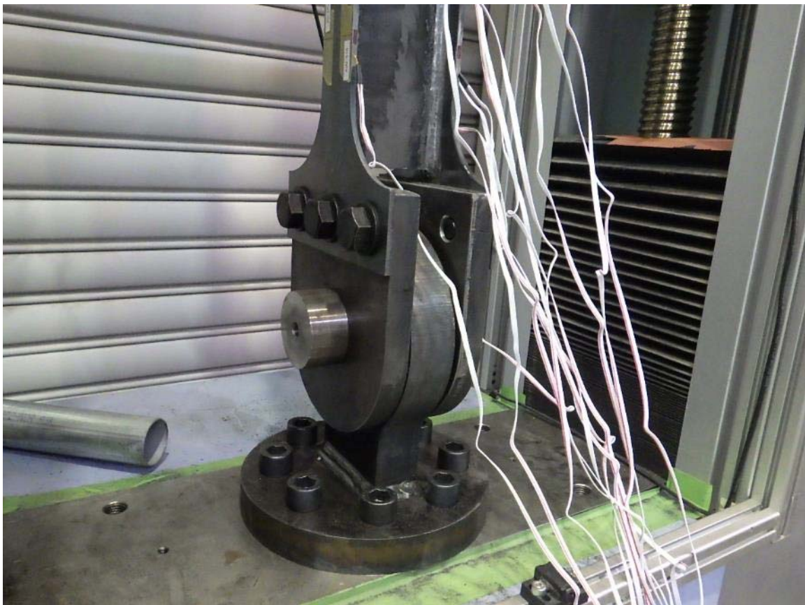
写真-付 6.2 下側ヒンジ部の設置状況
