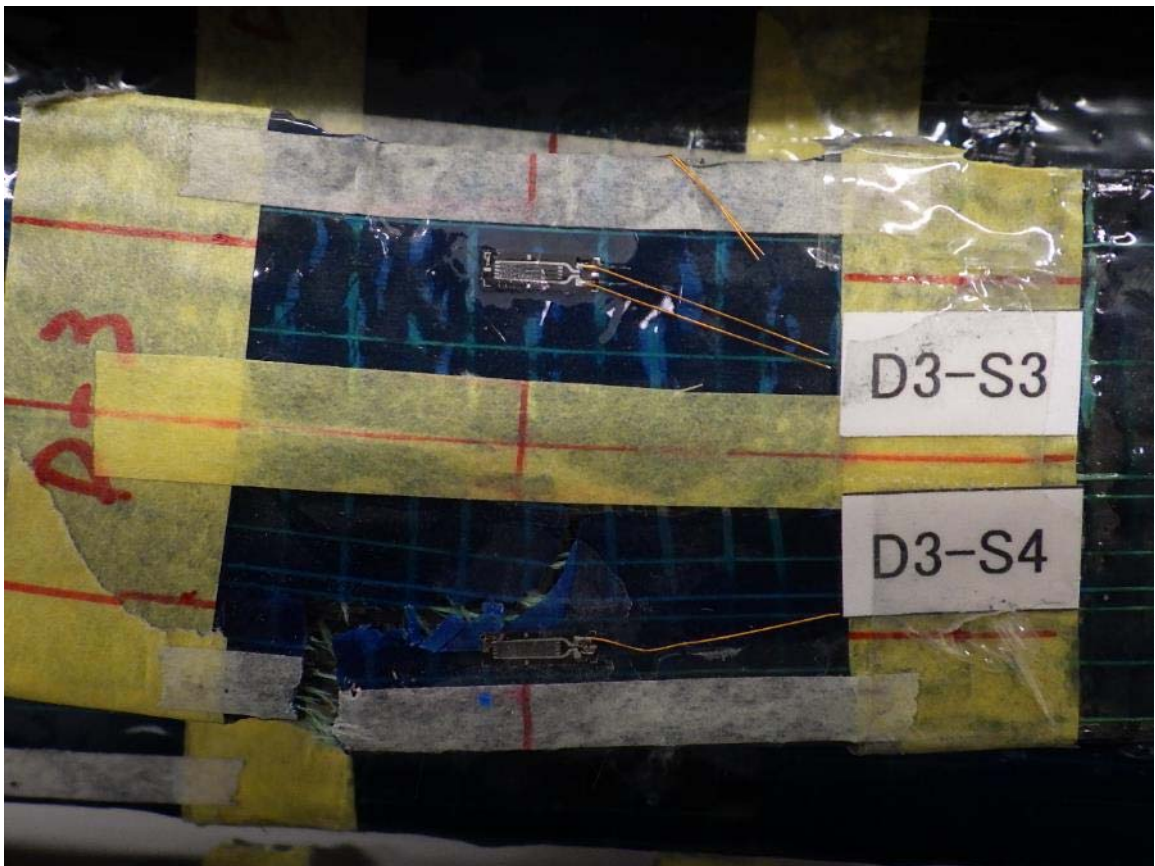
写真-付 4.23 曲げ載荷試験後における CFRP の破壊状況 (試験体 D-b 幅方向 表)
