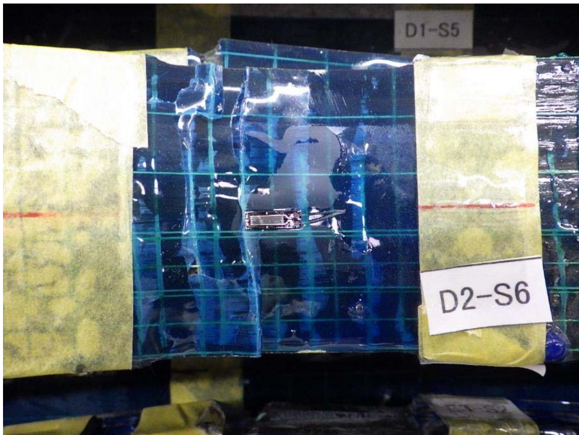
写真-付 4.9 圧縮荷重試験後における CFRP の破壊状況 (試験体 D-c 幅方向 圧縮側)
