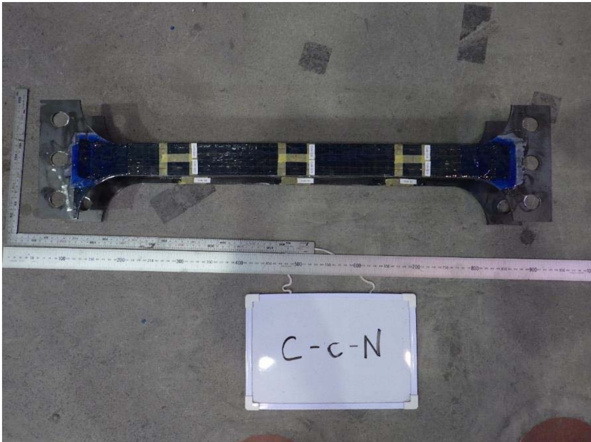
写真-付 6.30 圧縮試験後の試験体（試験体 C-c-N）（その 2）
