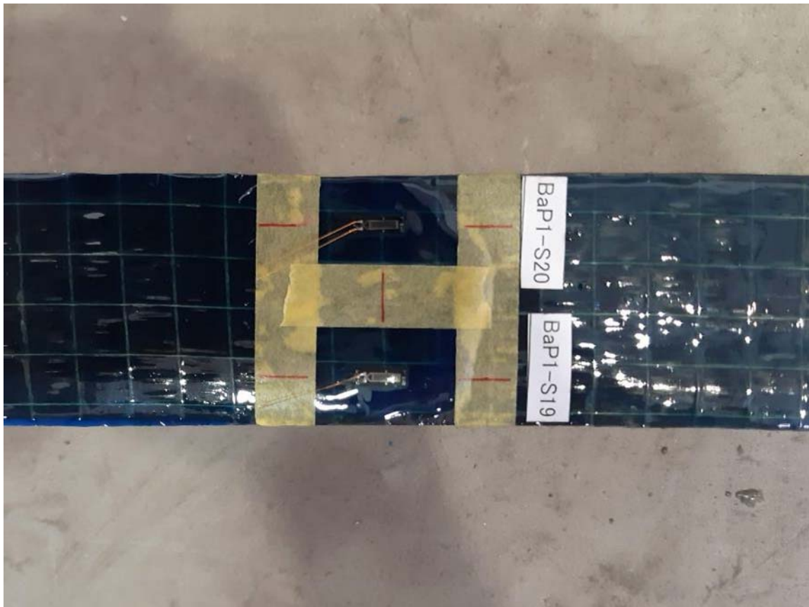
写真-付 6.46 交番载荷試験後の試験体（試験体 B-a- P1）（その 4）
