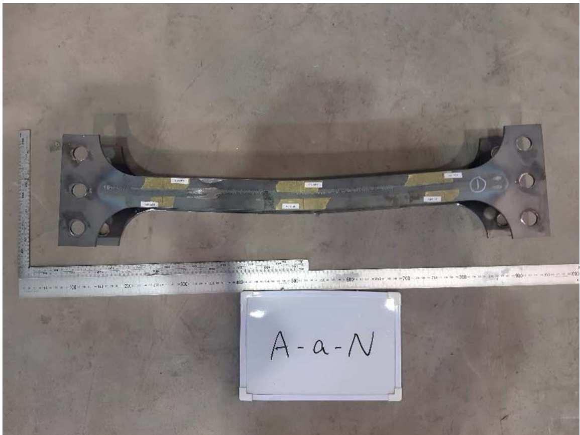
写真-付 6.37 交番載荷試験後の試験体（試験体 A-a-N）（その 1）
