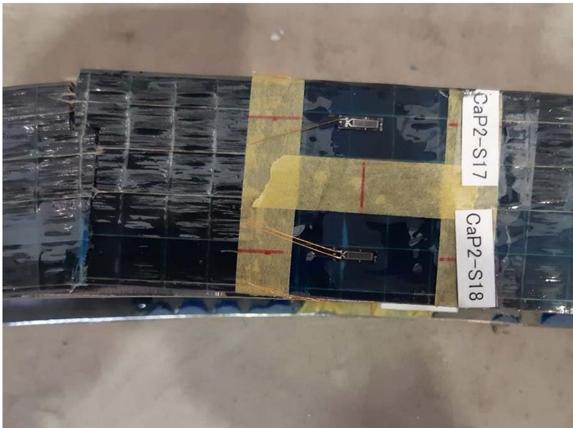
写真-付 6.59 交番载荷試験後の試験体（試験体 C-a- P2）（その 3）
