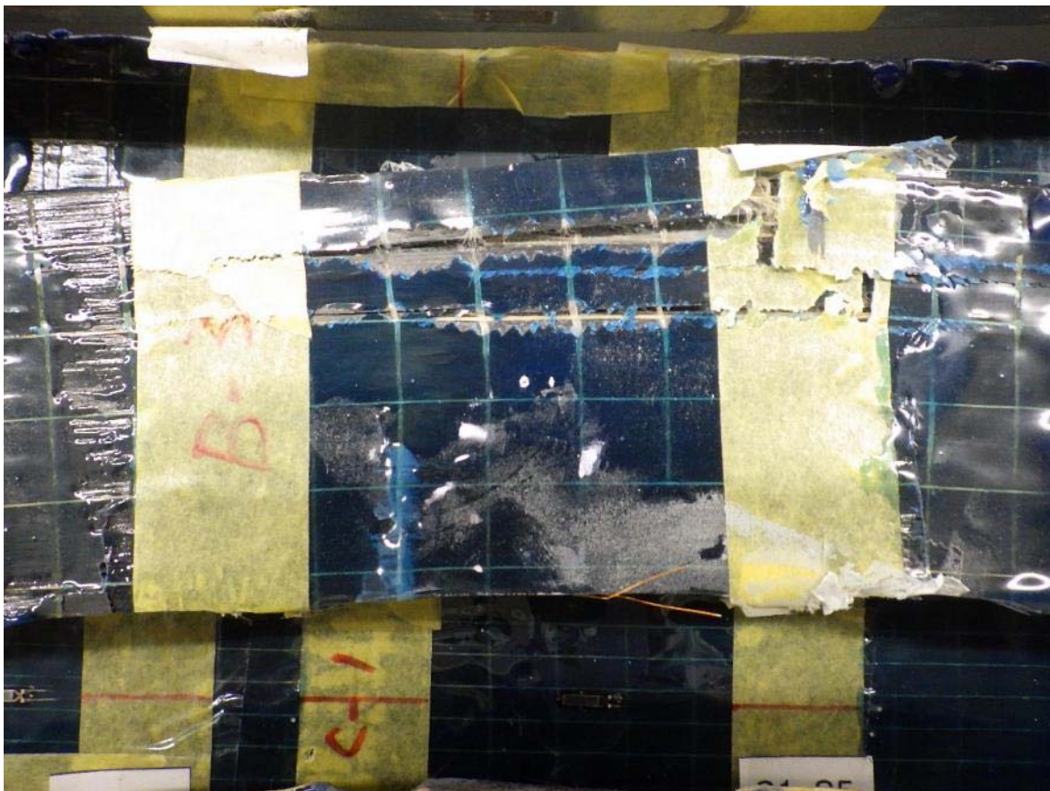
写真-4.12 曲げ荷重試験後における CFRP の破壊状況 (試験体 B-b 幅方向 裏)
