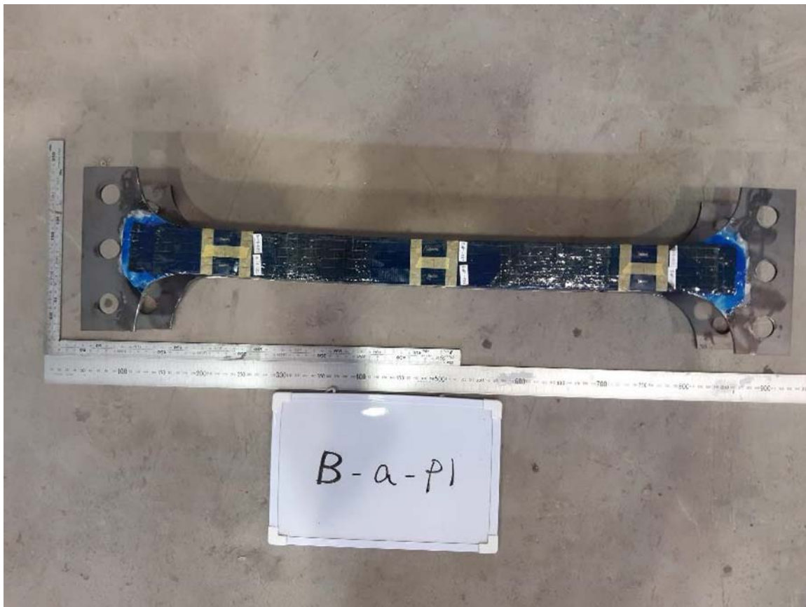
写真-付 6.43 交番载荷試験後の試験体 (試験体 B-a-P1) (その 1)
