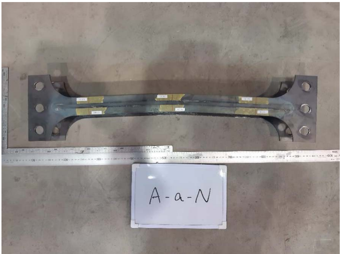
写真-付 6.38 交番載荷試験後の試験体（試験体 A-a-N）（その 2）
