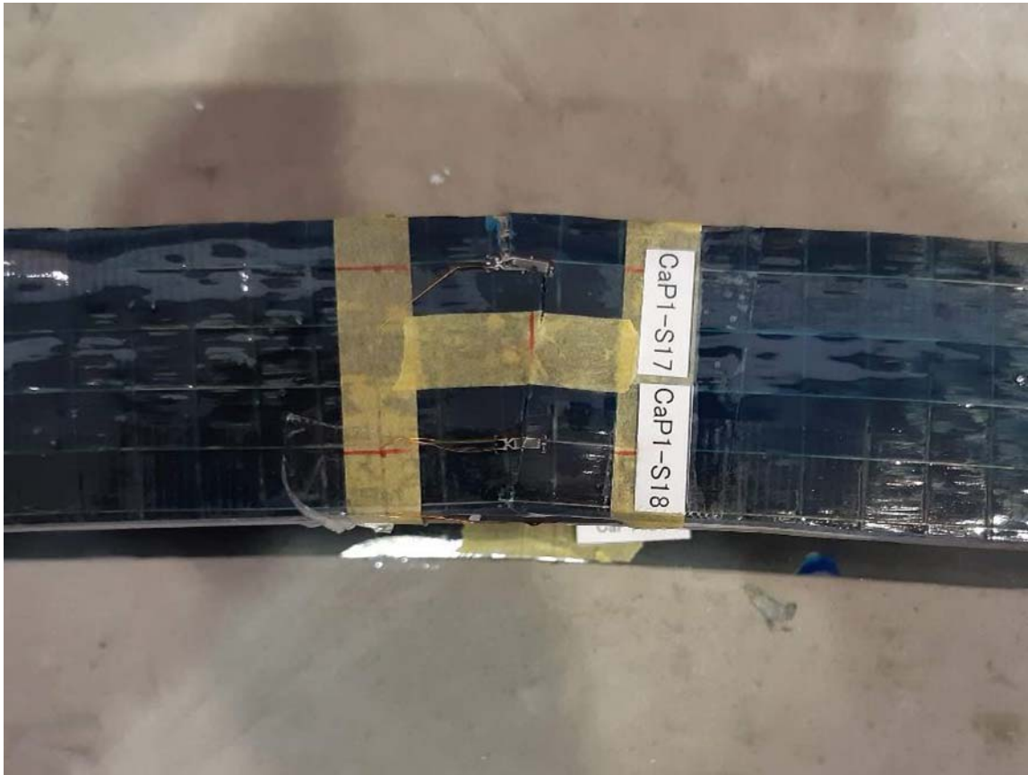
写真-付 6.55 交番載荷試験後の試験体（試験体 C-a- P1）（その 3）
