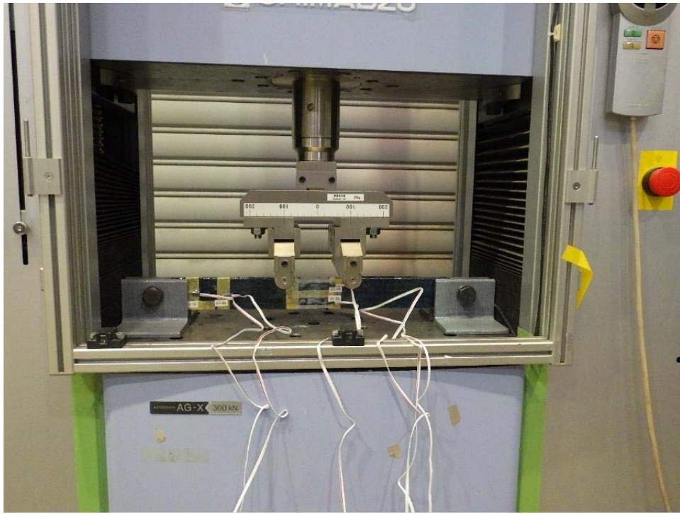
写真-4.3 曲げ荷重試験の実施状況
