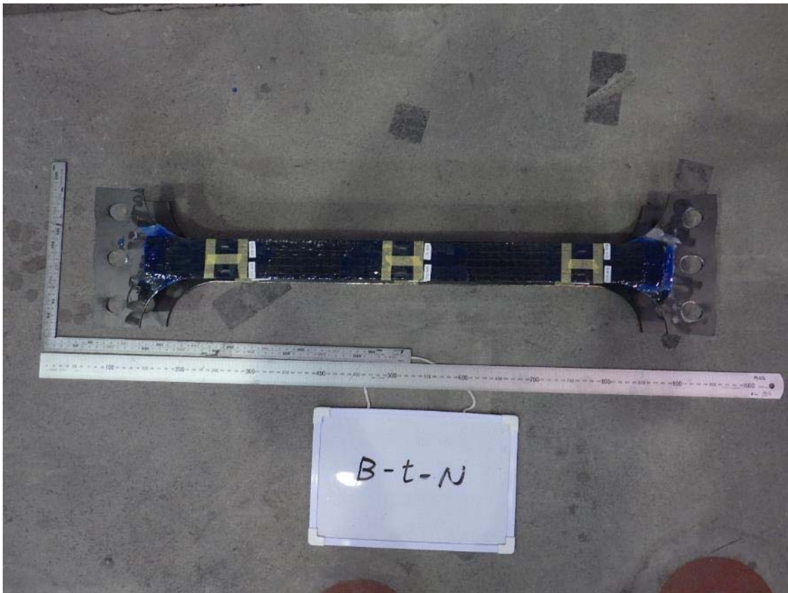
写真-6.3 引張試験後の試験体（試験体 B-t-N）
