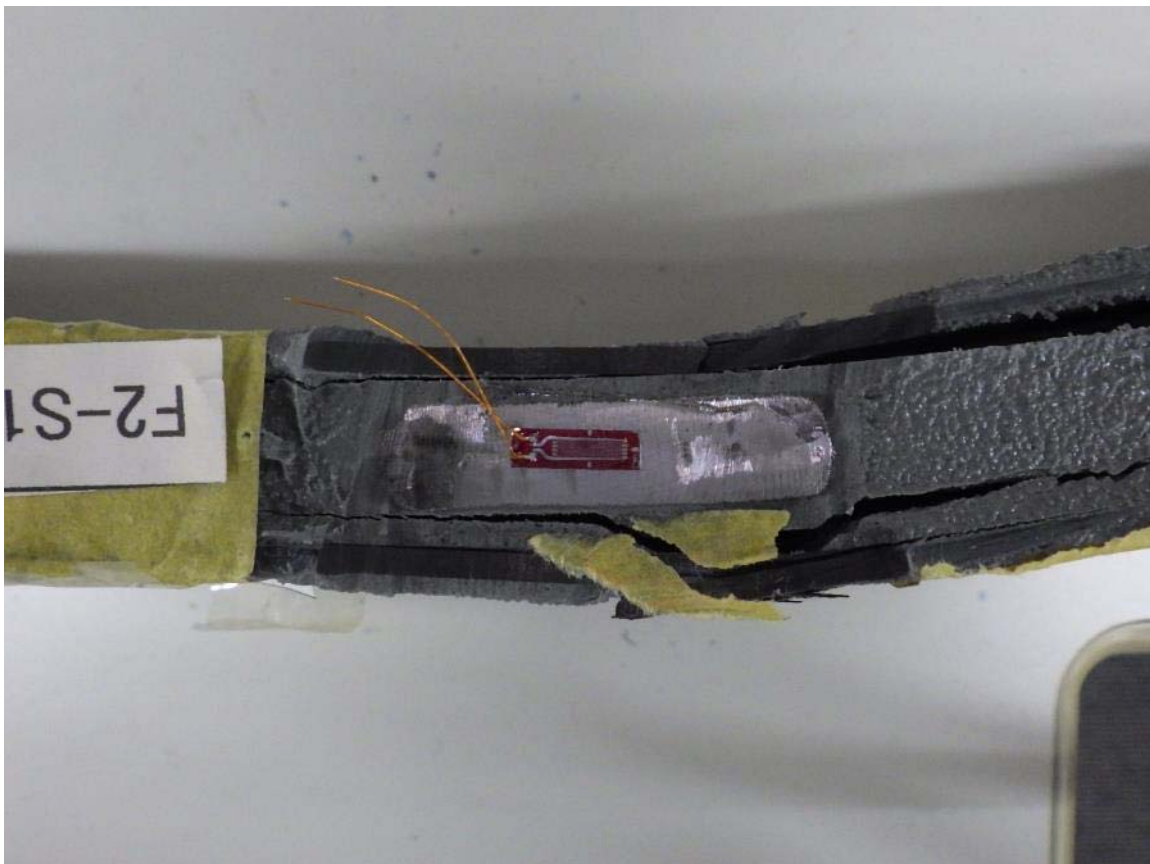
写真-付 4.18 圧縮載荷試験後における CFRP の破壊状況 (試験体 F-c 板厚方向 圧縮→引張側)
