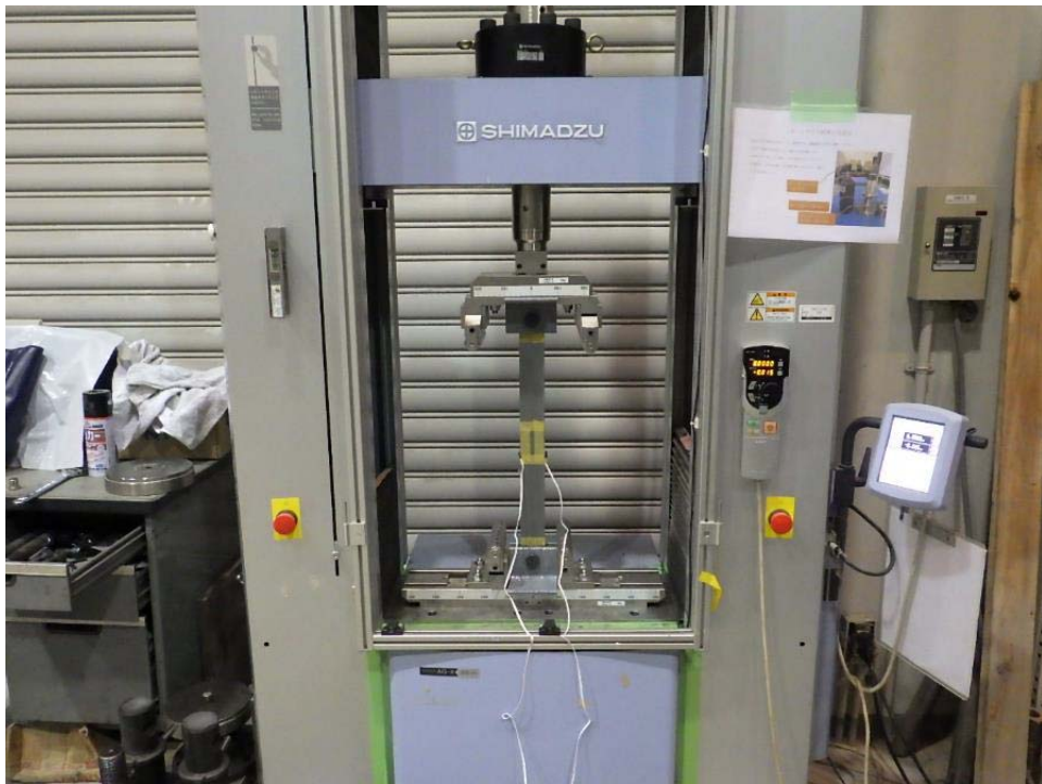
写真-4.2 圧縮载荷試験の実施状況
