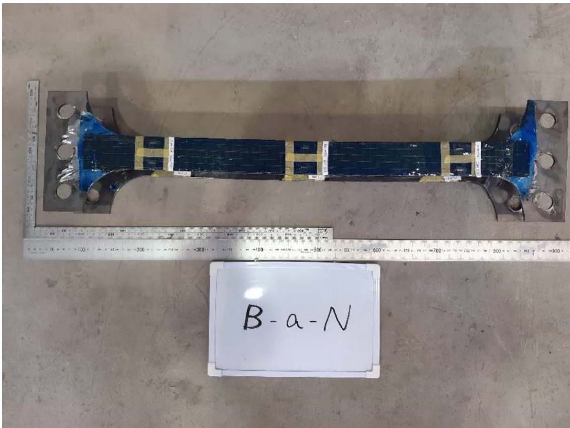
写真-付 6.40 交番载荷試験後の試験体（試験体 B-a-N）（その 2）
