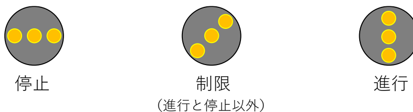
図5 中継信号機の信号
