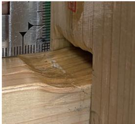
図6 柱の変形
