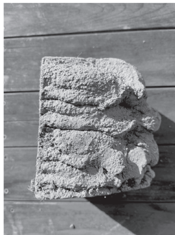
写真 24 Polyuse から提供を受けた 3D プリンタ造形物の断面
