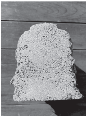
写真 24 Polyuse から提供を受けた 3D プリンタ造形物の断面
