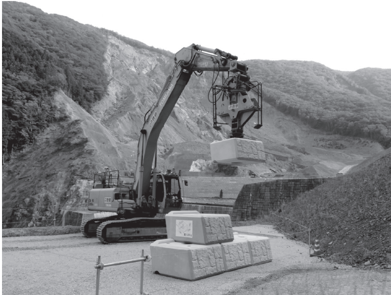
写真16 自動化施工仕様のバックホウによるデモ
