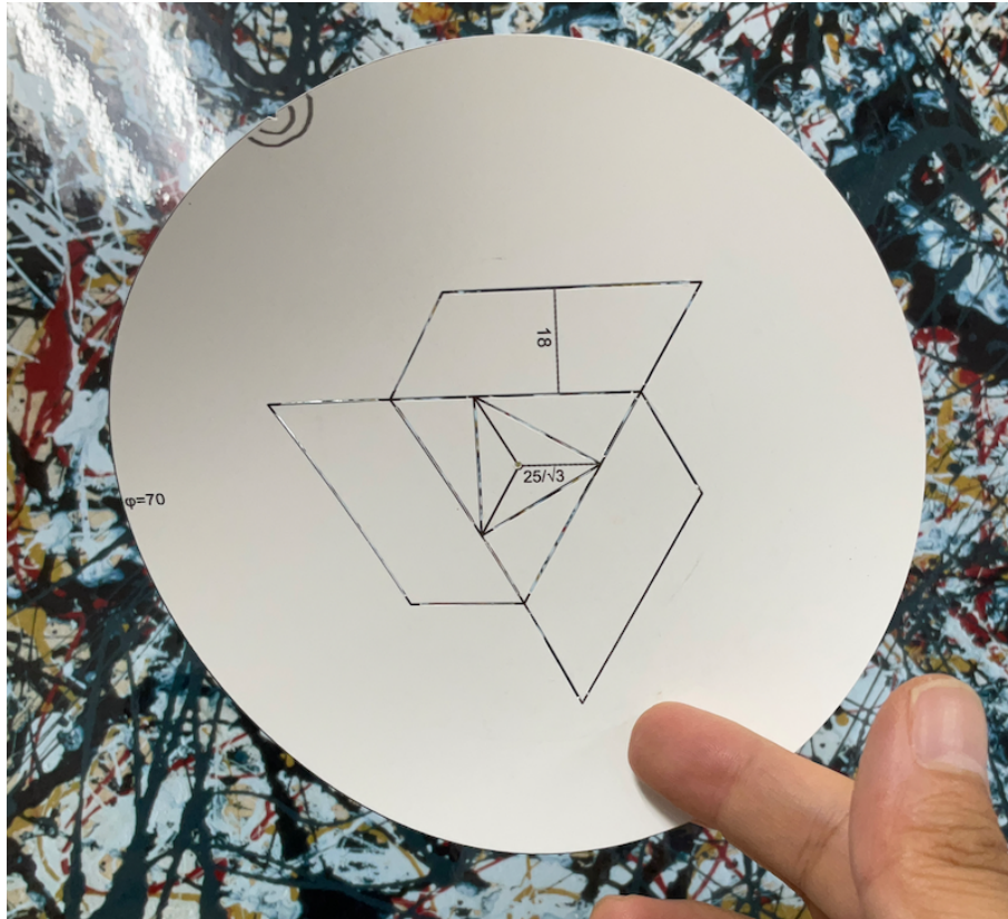
図 3.7 図 3.1(a) に示す RES の折り切り線をユポ紙に描くための型紙。折り切り線の部分にスリットを切っており、これを両面で一致させてシートに転写し、表裏のずれを最小限に抑えた。
