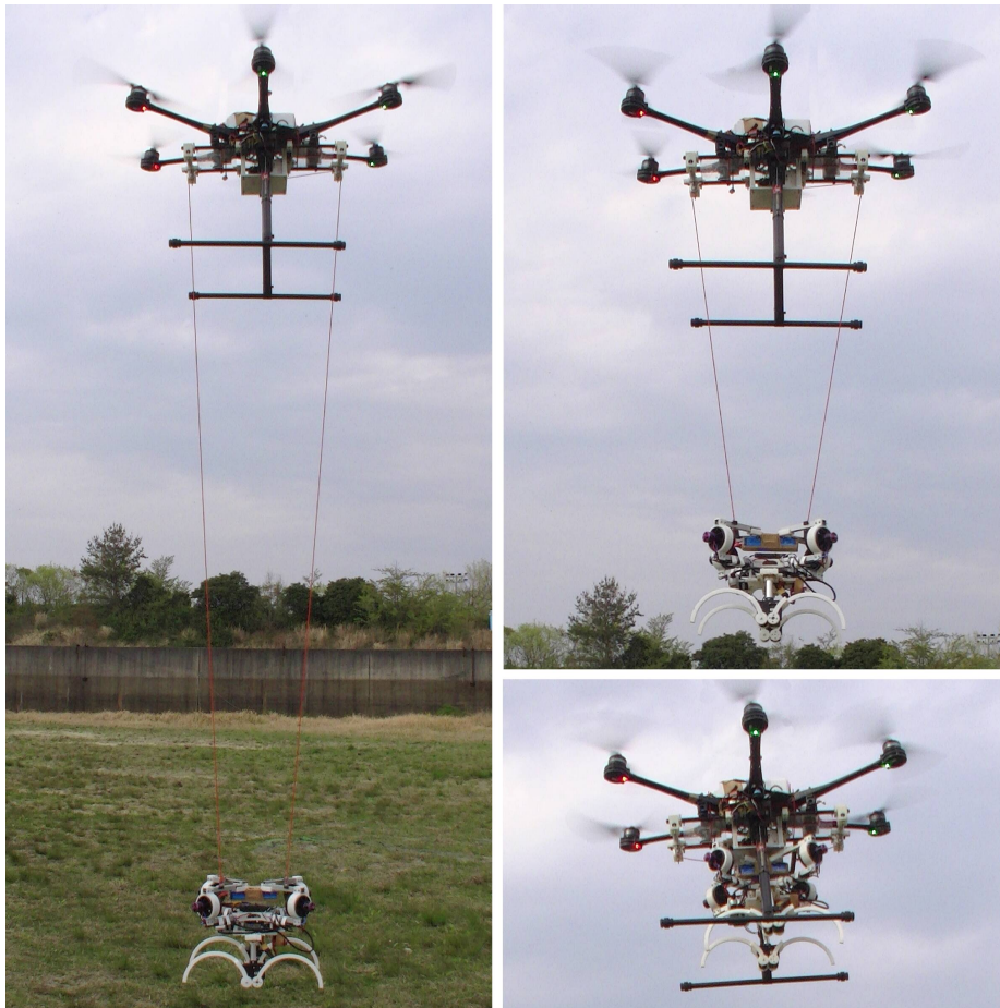
図 6.2: ワイヤ懸架ハンドを利用したロングリーチ空中マニピュレーション. ピックアップ・ブレース作業時にはワイヤ懸架ハンドをマルチロータ UAV から 3m(左図) 吊り下げた. 遠距離移動時にはワイヤ懸架ハンドをつり上げ(右上図), マルチロータ UAV の直下に収めた状態(右下図) にできる [80](©2019 IEEE).
