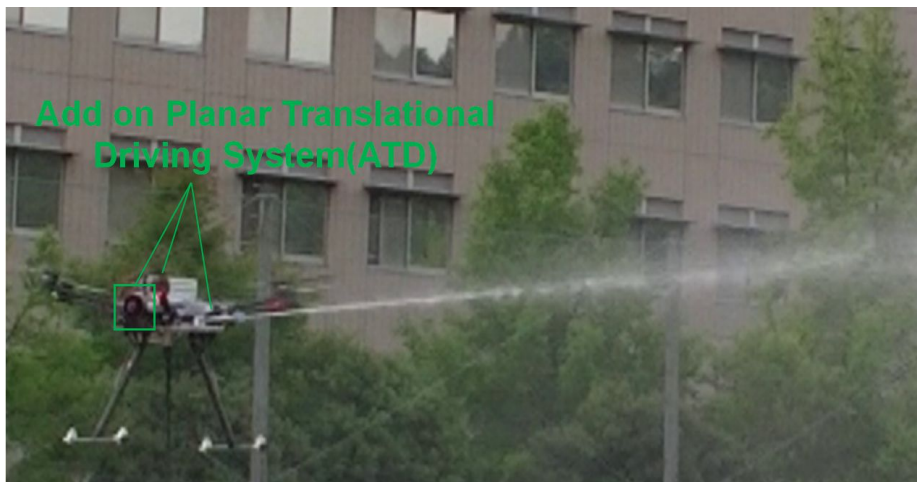
図 5.1: アドオン型水平並進駆動モジュールを搭載したマルチロータ UAV の高圧洗浄作業.
