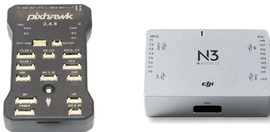
図 2.3: Pixhawk フライトコントローラ (左) と DJI N3 フライトコントローラ (右).
