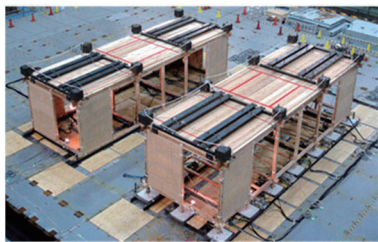
図1 振動台実験における試験体
