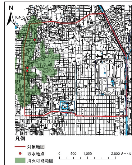
図 12 都市型水害対策車 を用いた消火可能範囲図
