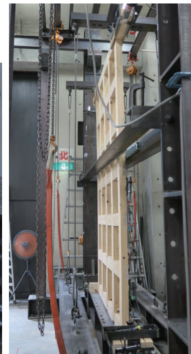
写真3 試験体の座屈の様子と治具による拘束
