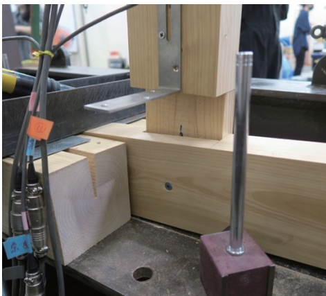
写真2 柱脚のずれ変形の様子
