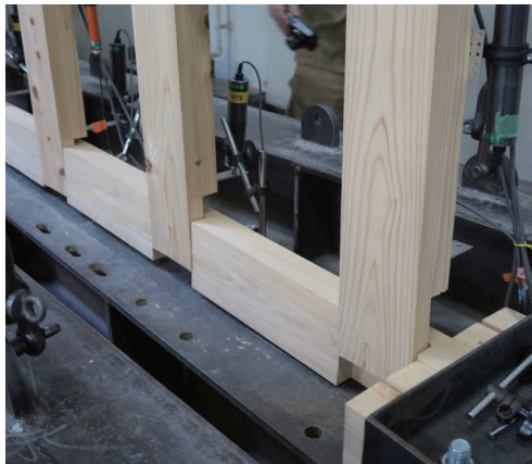
写真2 柱脚のずれ変形の様子
