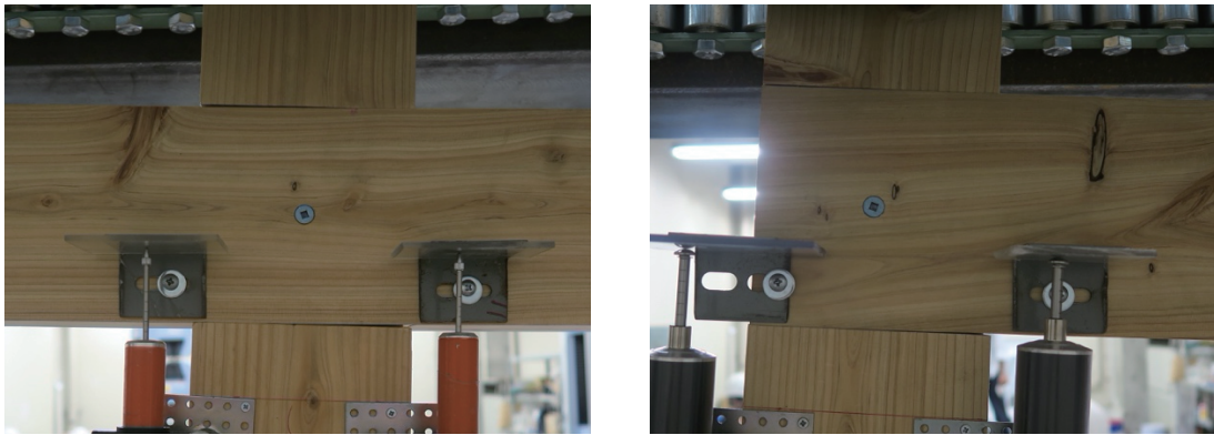
写真4 接合部の回転変形の様子（左がJ3／右がJ1）
