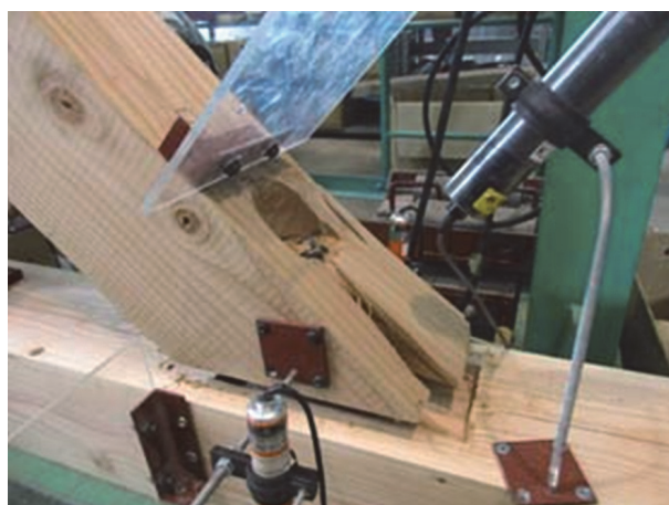
写真12 方杖端部の割裂
